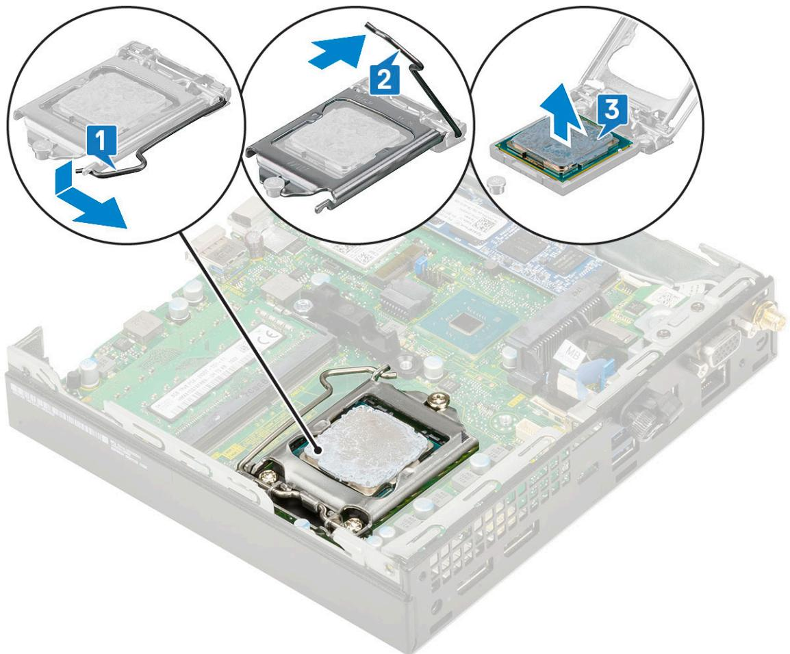
**i** **註:** 卸下處理器後，將其置於防靜電的容器中，以便再利用、退回或暫時存放。請勿碰觸處理器底部，以免損壞處理器接點。只可碰觸處理器側緣。
