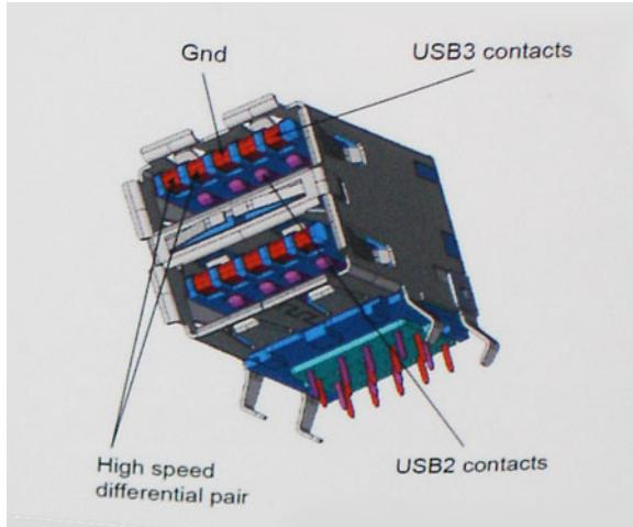
隨著高畫質影像內容、容量以 TB 計的儲存裝置、像素以百萬計的數位相機等產品推陳出新，使用者對資料傳輸速度需求與日俱增，USB 2.0 的傳輸速度似乎已經不夠看了。此外，沒有 USB 2.0 連線可以接近 480 Mbps 的理論最大輸出，讓資料輸出的最大速率始終停留在約 320 Mbps (40 MB/秒) 的水準，也就是實際最大資料輸送量。同樣地，USB 3.0/USB 3.1 Gen 1 連線也無法達到 4.8 Gbps，但我們仍能預期它實質上的最高速率將可達到 400 MB/秒，表示 USB 3.0/USB 3.1 Gen 1 的傳輸速率是 USB 2.0 的 10 倍之多。
