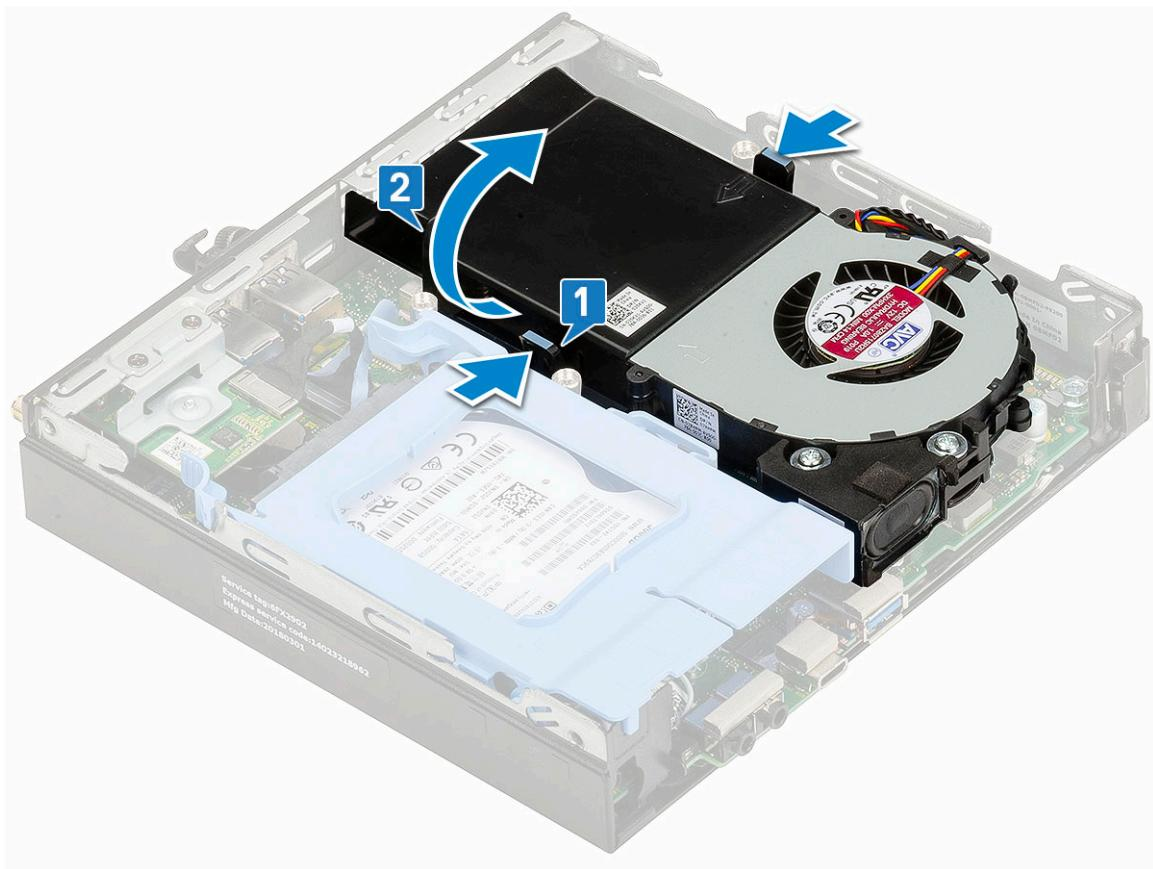
4. 從主機板上的連接器拔下喇叭纜線和散熱器鼓風機纜線。
