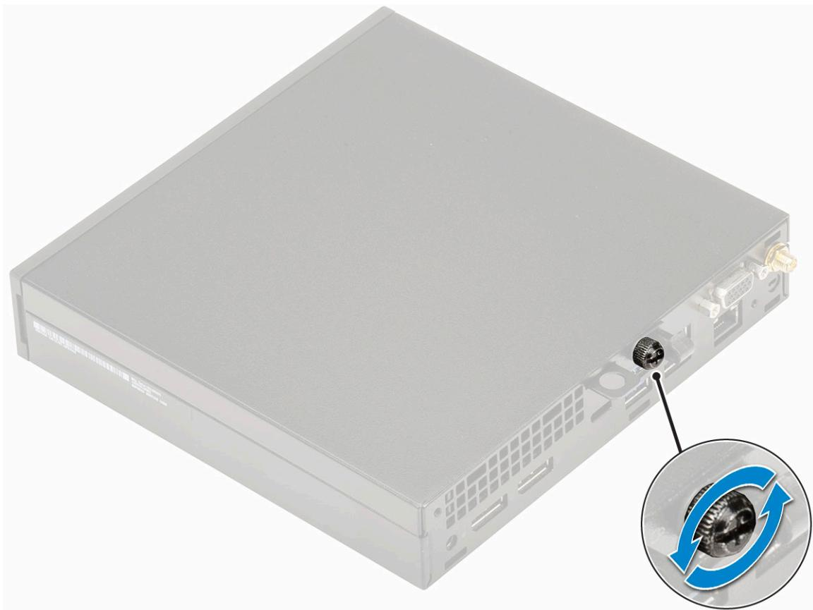
b. 將側蓋朝系統正面推動，然後抬起側蓋以從系統卸下。
