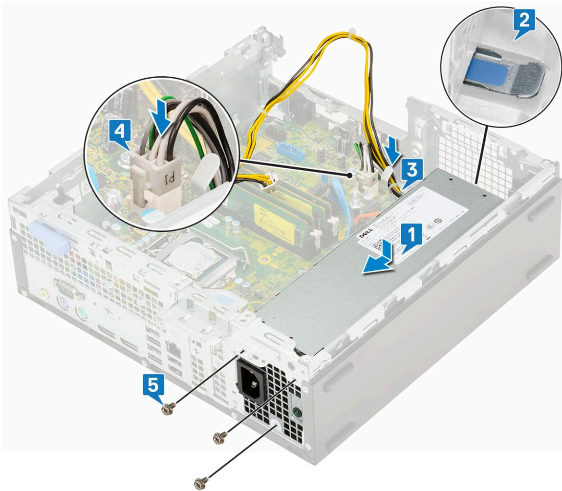
5. CPU 電源ケーブルを固定クリップに通して配線します [1]。
