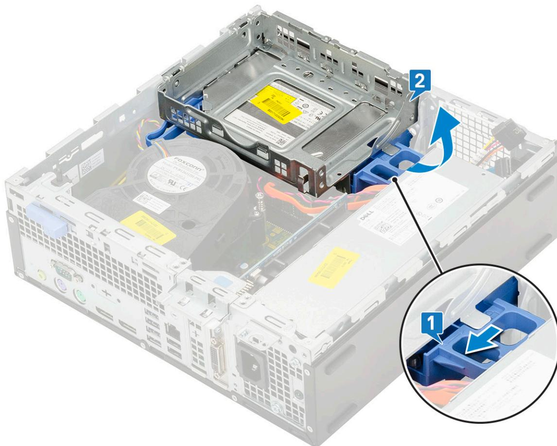
4. ハードドライブと光学ドライブモジュールを取り外すには、次の手順を実行します。
