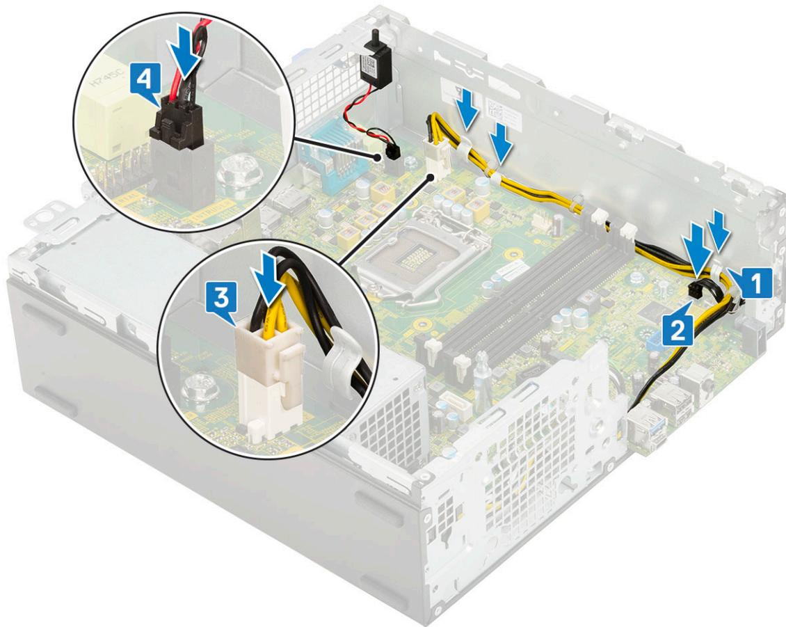
6. 電源ケーブル、オプティカルドライブデータケーブル、ハードドライブデータケーブルを接続します [1、2、3]。
