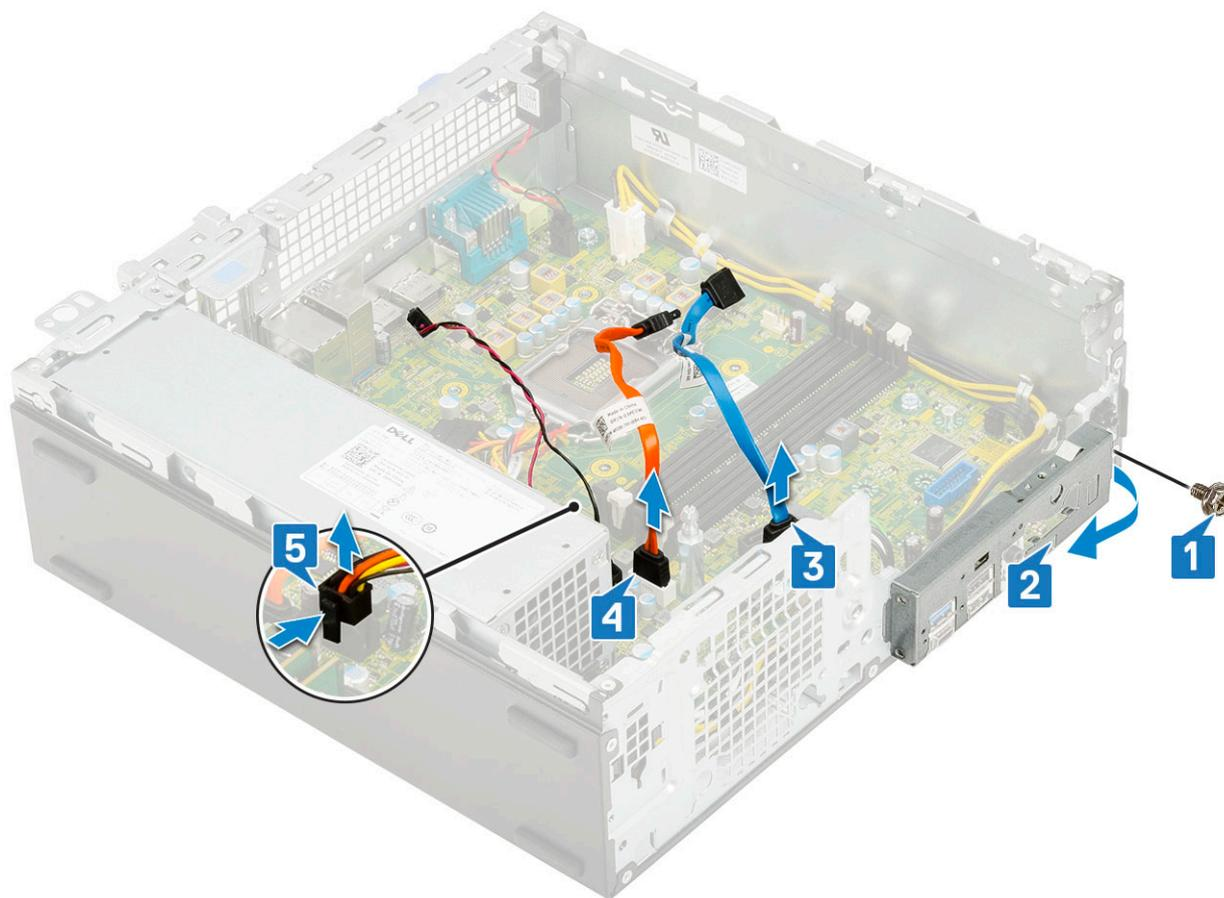
4. 次のケーブルをシステム基板のコネクタから外します。
