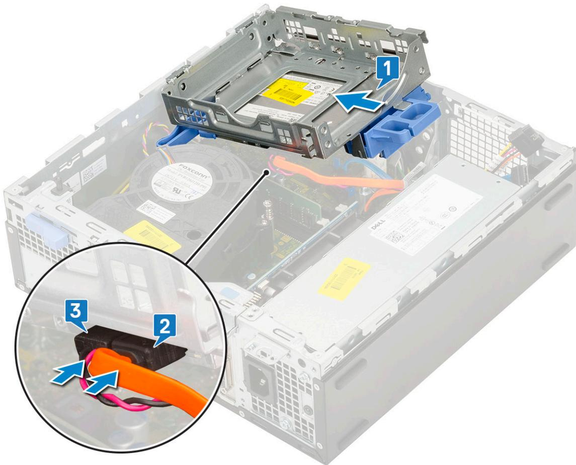
3. ハードドライブと光学ドライブ モジュールを下げてスロットに挿入します [1]。
