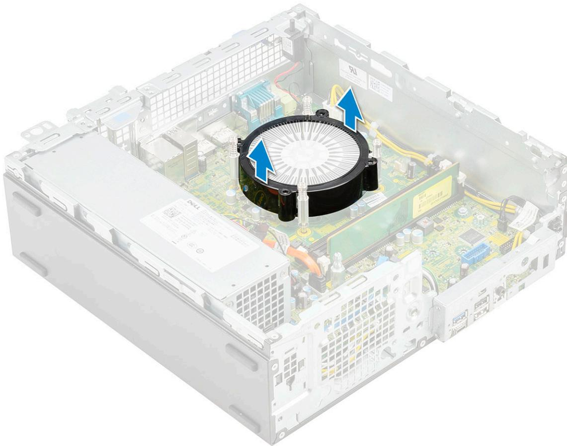
b. ヒートシンクを固定している4本のキャプティブスクリューを緩め[1]、ヒートシンクを持ち上げてシステムから取り外します[2]。
