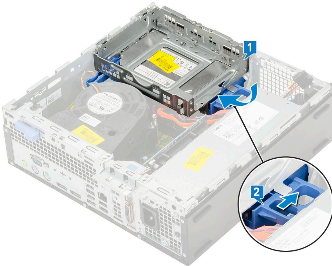
5. ハードドライブ データ ケーブルと電源ケーブルを HDD-ODD リリースタブに通して配線します [ 1 ]。
