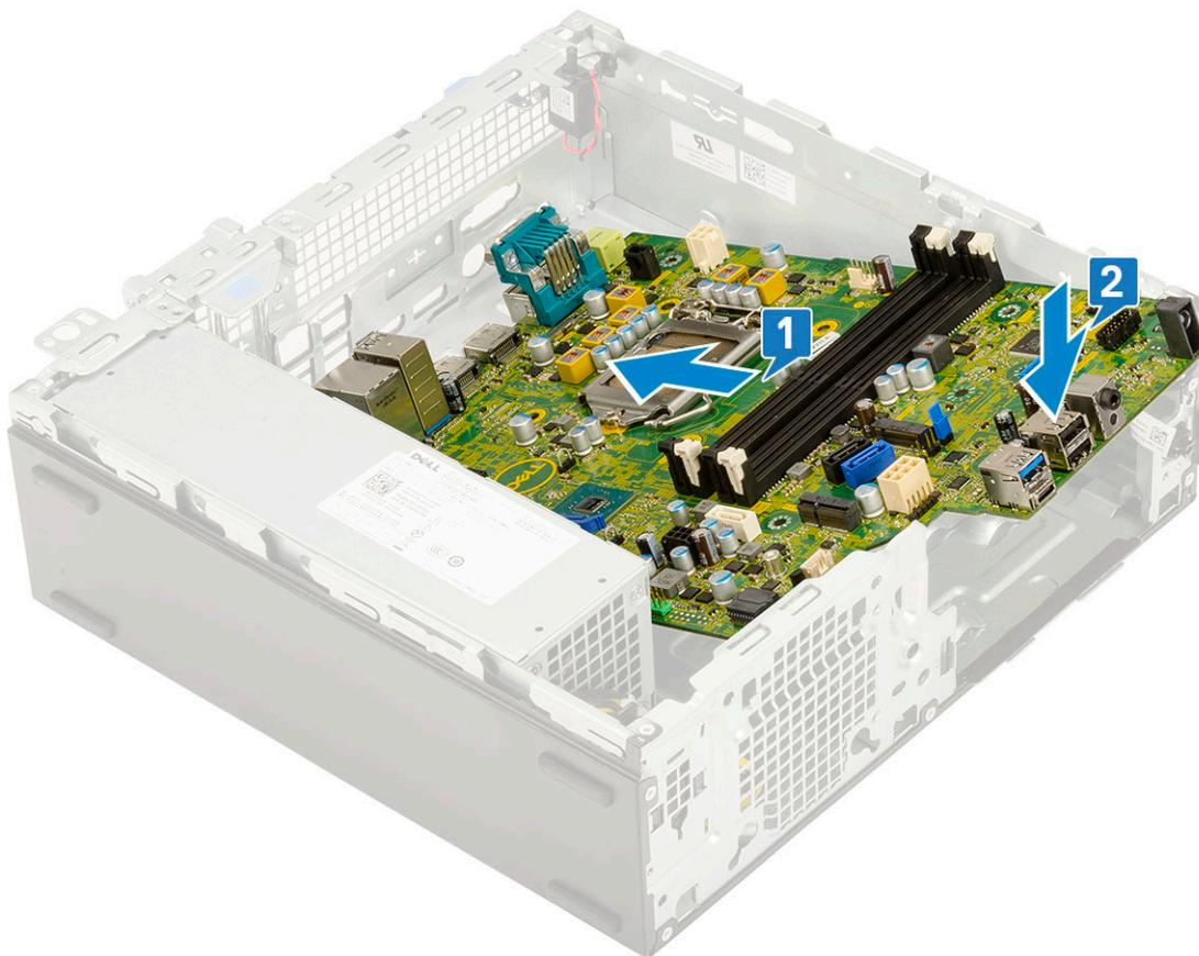
3. システム基板をシステムに固定する1本の (#6-32) ネジ、1本の (M3x5) ネジ、5本のネジを取り付けます [1、2]。
