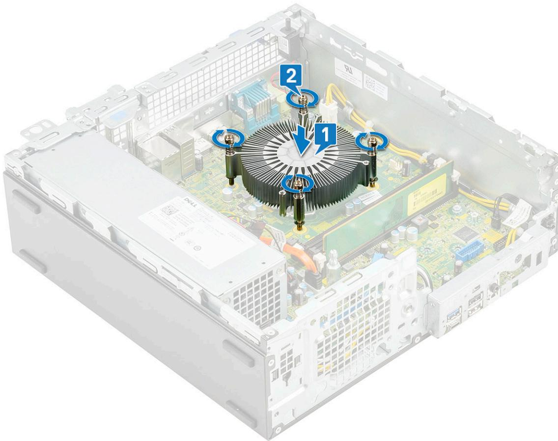
3. ヒートシンク カバーをヒートシンクにセットします。
