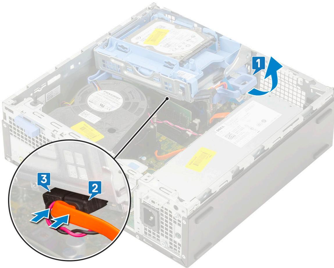
4. ハードドライブ データ ケーブルとハードドライブ電源ケーブルをハードドライブのコネクタに接続します [1、2]
