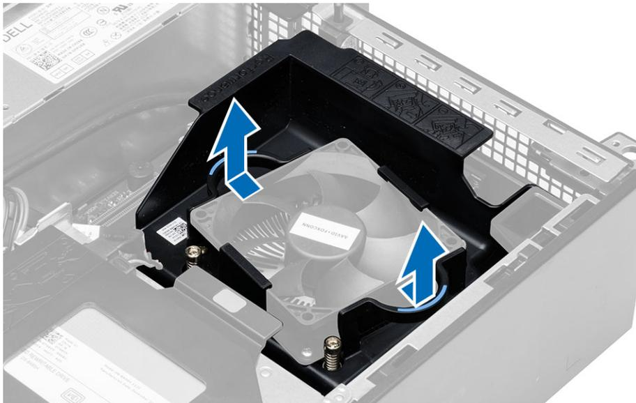
4. 断开风扇电缆与系统板的连接。拧松固定螺钉，提起散热器部件，然后将其从计算机中卸下。
