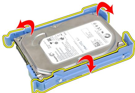
5. 拧下用于将小型硬盘驱动器固定至硬盘驱动器支架的螺钉，然后将硬盘驱动器从其支架中卸下。
