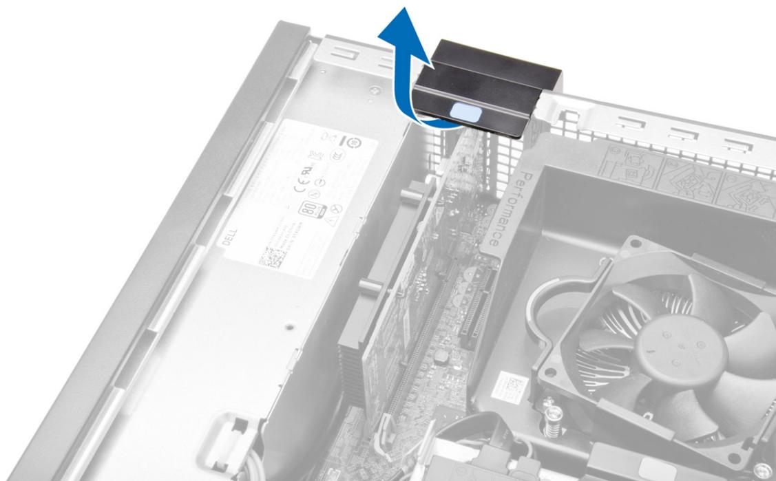
4. 将释放拉杆拉离扩充卡，直到将固定卡舌从插卡凹槽中释放出来。然后，从其连接器中提起插卡并将其从计算机中卸下。
