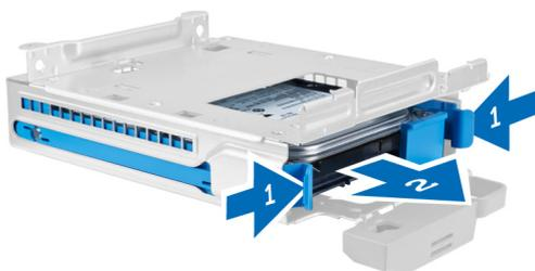
4. 弯曲硬盘驱动器支架，然后将硬盘驱动器从支架中卸下。
