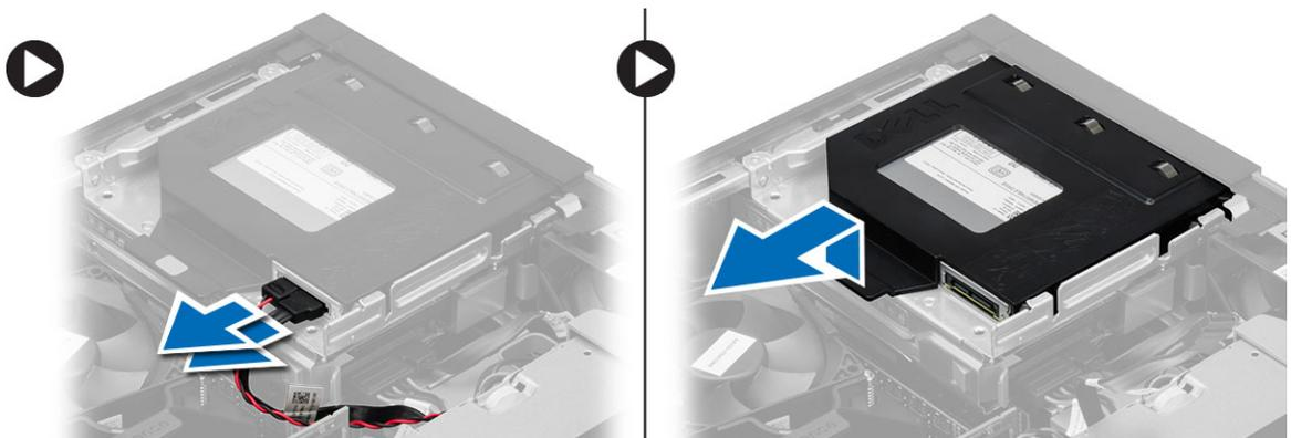
5. 弯曲光盘驱动器支架，然后将光盘驱动器提离支架
