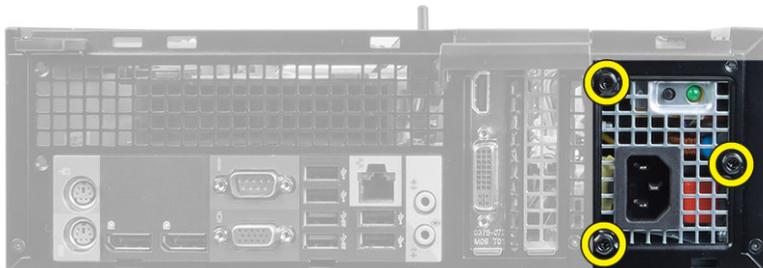
6. 向内按压蓝色释放卡舌，然后将电源设备向计算机正面滑动。
