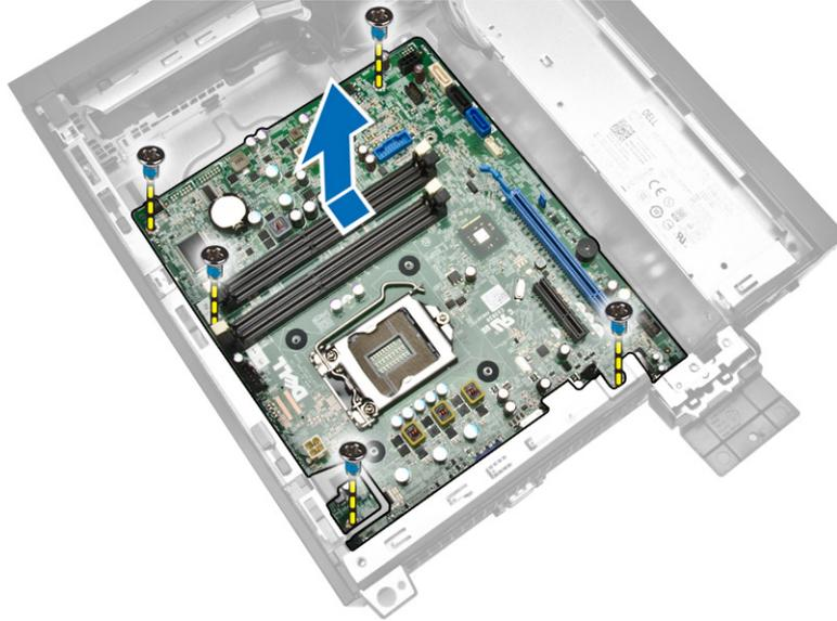
6. 将系统板倾斜 45 度，然后将系统板从计算机中提出。
