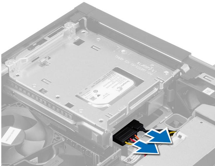
4. 将蓝色驱动器固定框架手柄向着解锁位置滑动，然后从计算机中提起硬盘驱动器固定框架。
