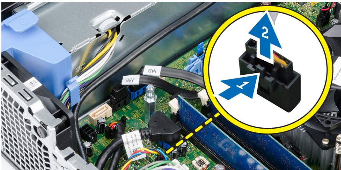
4. 将系统风扇撬离将其固定到计算机的索环并卸下。然后，沿插槽向内按下索环并穿过机箱。
