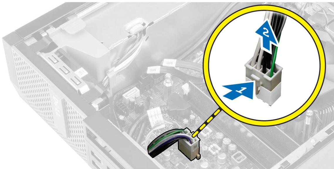
4. 断开 4 针电源电缆与系统板的连接。
