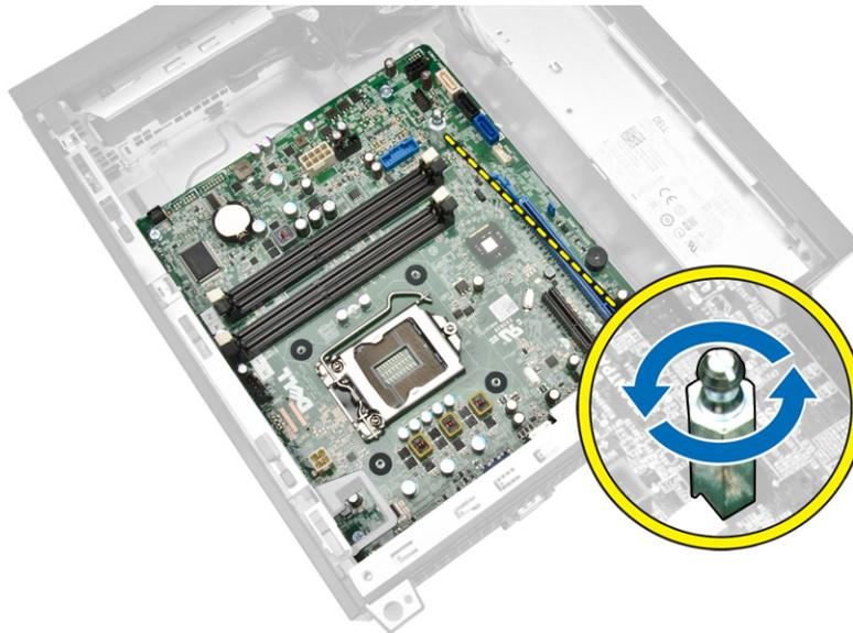
5. 拧下用于将系统板固定到计算机的螺钉，然后将系统板向计算机正面滑动。
