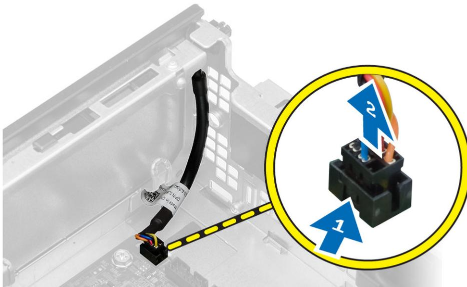
4. 按下电源开关两侧的固定夹，将其从机箱中松开，然后将电源开关及其电缆从计算机上卸下。
