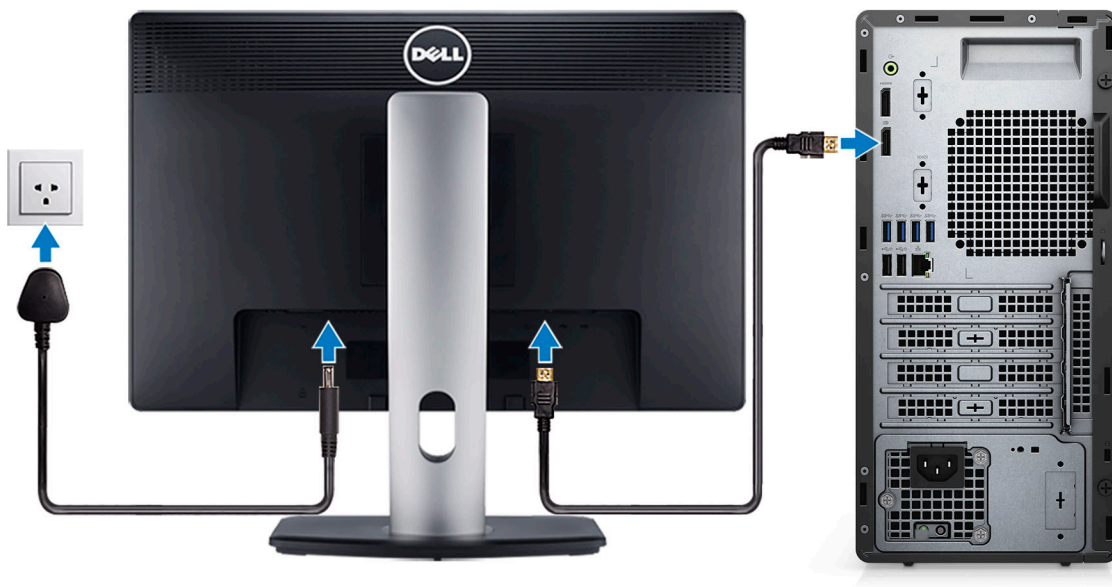
4. Подсоединение кабеля питания.
