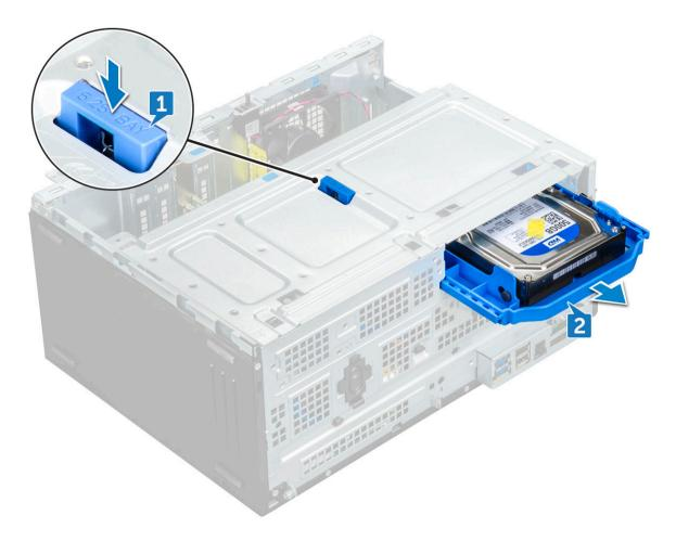
○ 註: 彈片可能會顯示 5.25 吋,表示您也可以在相同的硬碟支架中安裝 5.25 吋硬碟。
