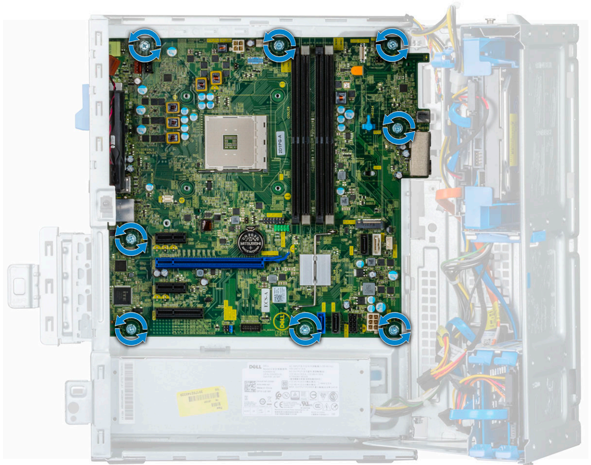
b החלק והרם את לוח המערכת והוצא אותו מהמחשב [2].
