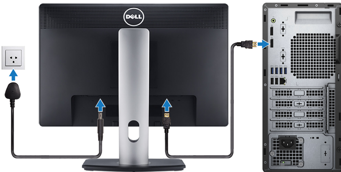
4. Branchement du câble d'alimentation.
