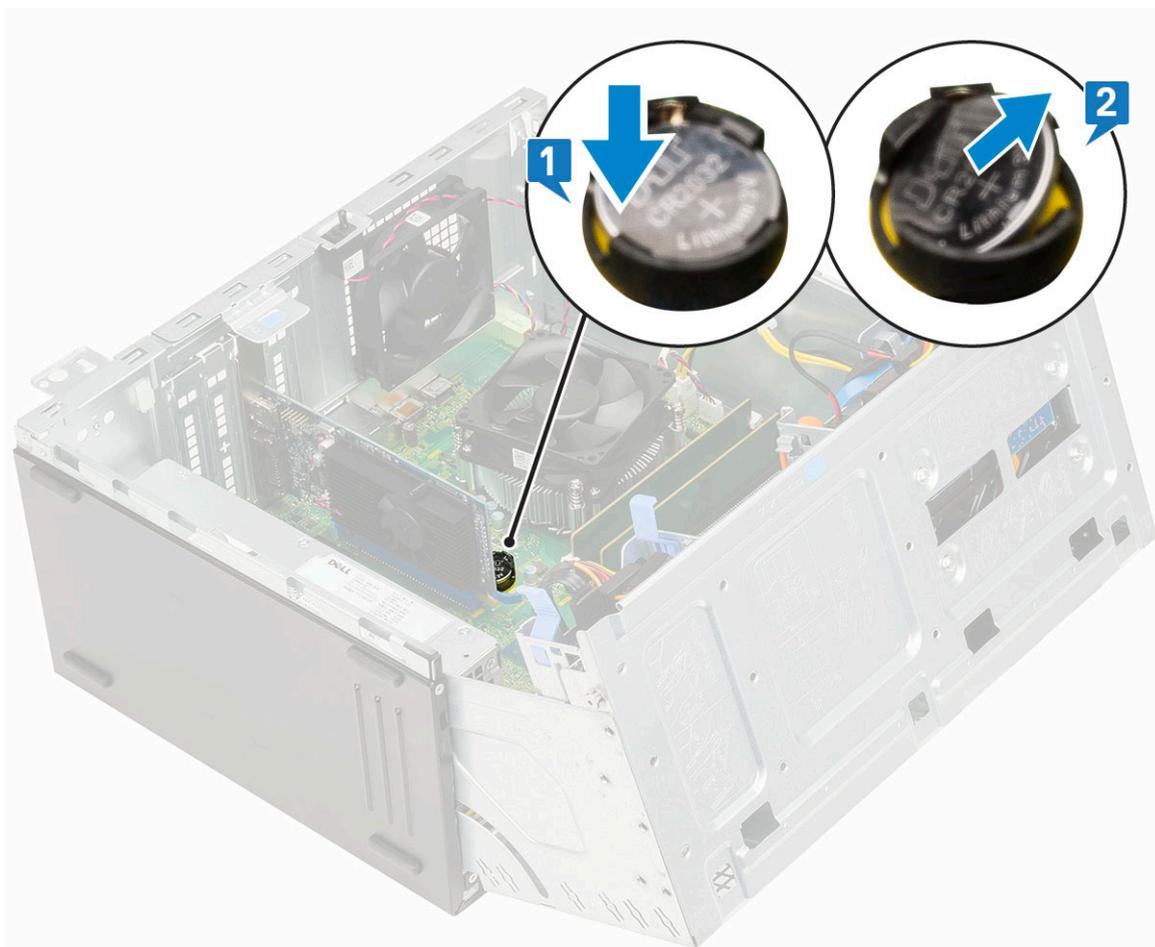
**i** **N.B.:** La rimozione della batteria a bottone può comportare la reimpostazione delle impostazioni e/o del BIOS della scheda di sistema
