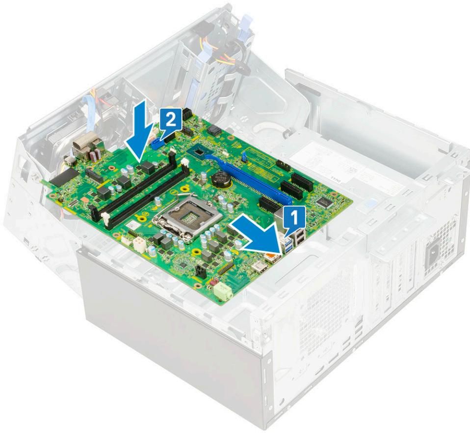
3. Ricollocare le viti per fissare la scheda di sistema al computer [1].
