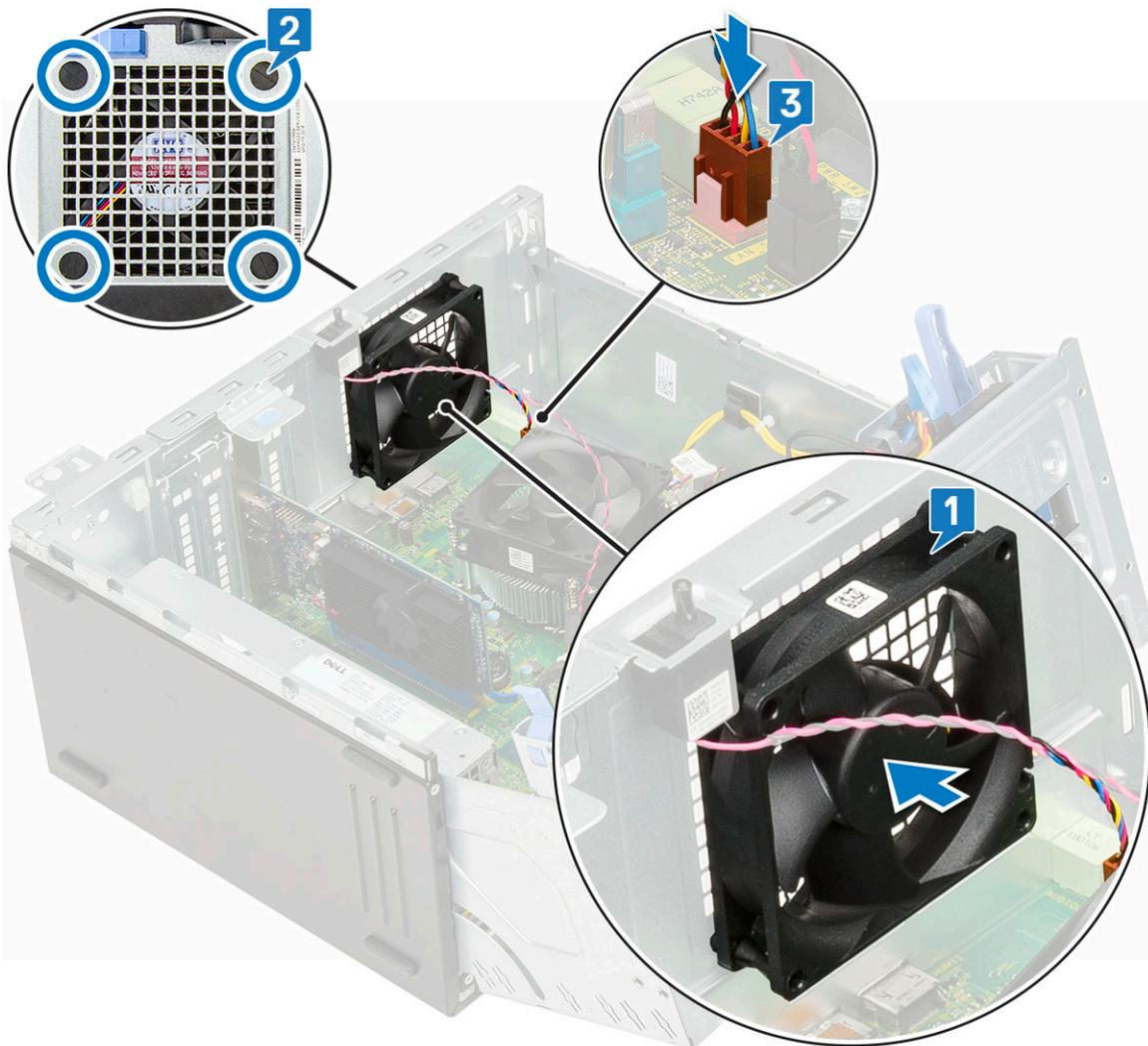
7. Faites passer le câble du commutateur d'intrusion dans le passe-câbles du ventilateur [2].
