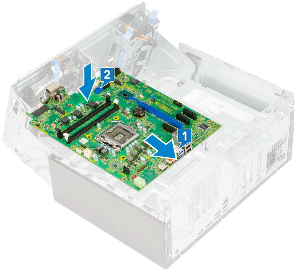
3. Remplacez les vis qui fixent la carte système au châssis de l'ordinateur [1].
