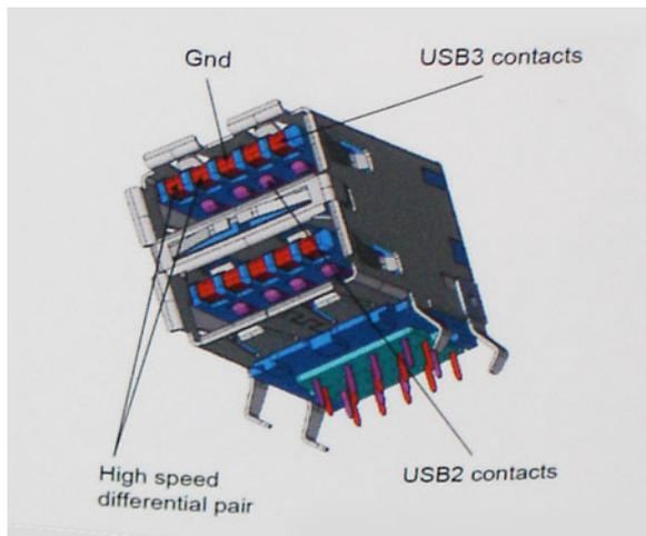
当今高清视频内容、TB 级存储设备、高百万像素级数码相机等领域的数据传输需求不断增长，USB 2.0 无法实现足够快的速度。此外，没有 USB 2.0 连接可以达到接近 480 Mbps 的理论最大吞吐量，而数据传输速度约为 320 Mbps (40 MB/s) - 这是实际的最大值。同样，USB 3.0/USB 3.1 Gen 1 连接也绝不会实现 4.8 Gbps 的速率。我们很可能在现实世界的开销方面看到高达 400 MB/s 的速率。USB 3.0/USB 3.1 Gen 1 的这一速率比 USB 2.0 提高了 10 倍。
