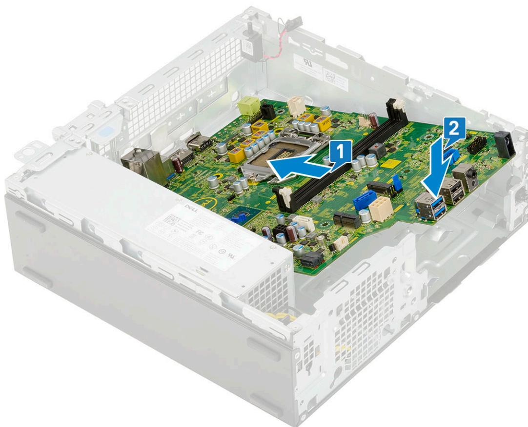
3. 拧上用作 M.2 SSD 驱动器固定点的一颗螺钉、定位器单颗 (#6-32) 螺钉和将系统板固定至系统的 5 颗螺钉 [1、2、3]。
