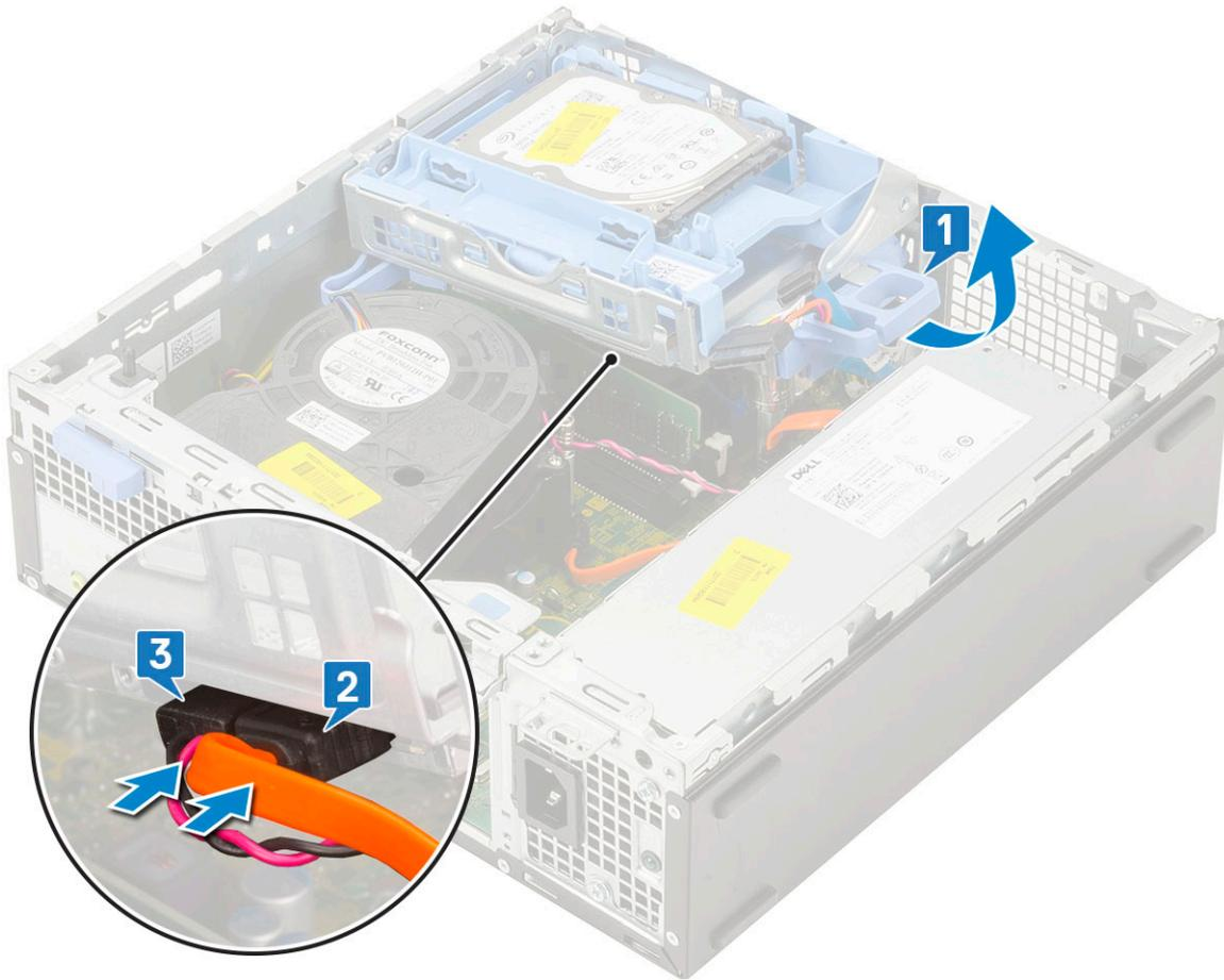
4. 将硬盘驱动器数据缆线和硬盘驱动器电源缆线连接到硬盘驱动器上的连接器 [1、2]。
