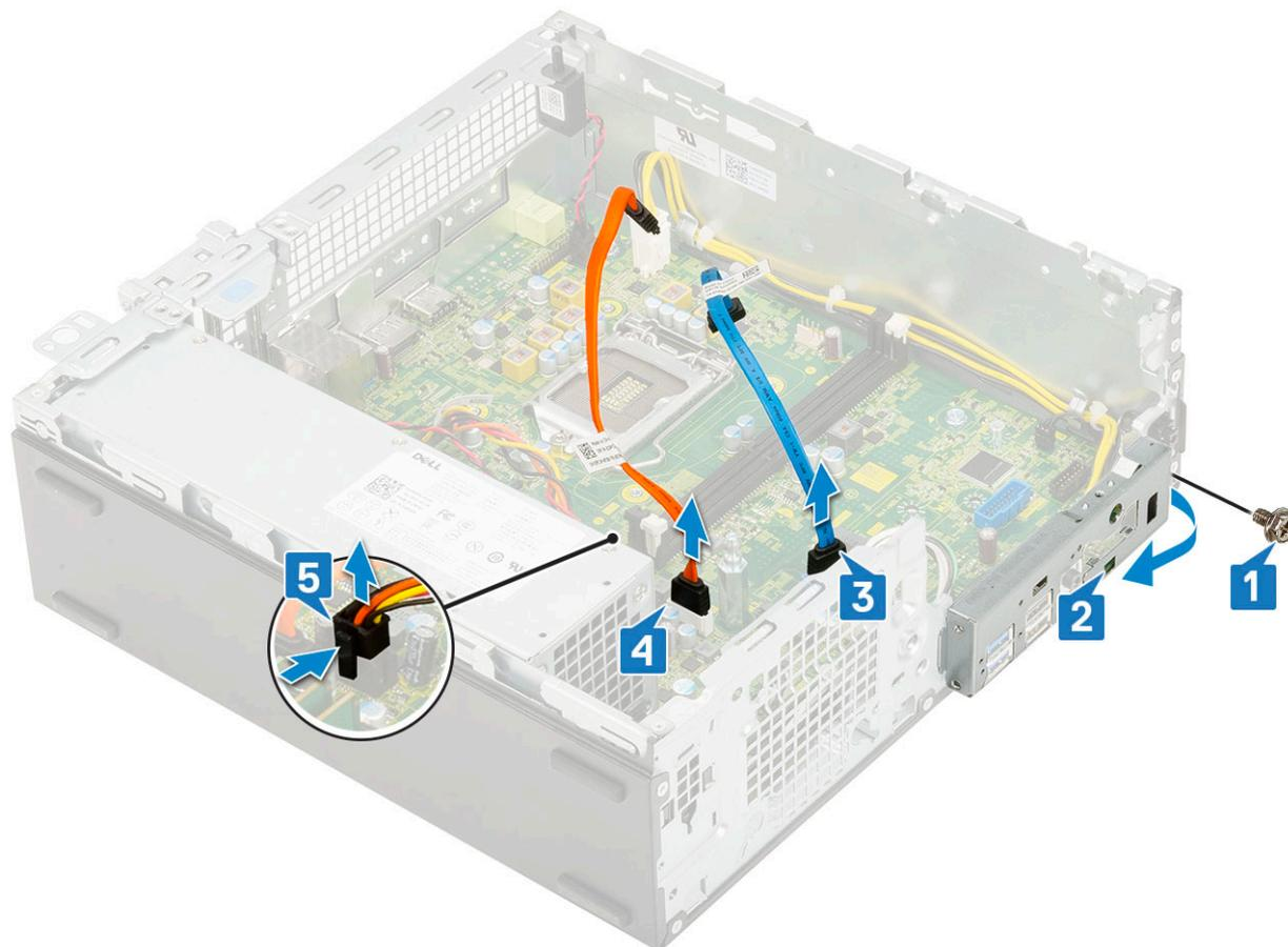
5. 断开以下缆线与系统板上连接器的连接：
