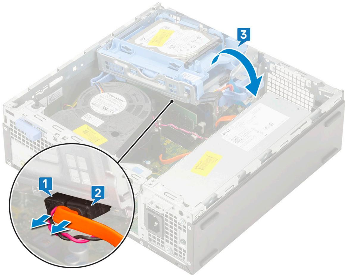
e) 推动光盘驱动器上的释放门锁 [1]，然后从系统拉出光盘驱动器 [3]。
