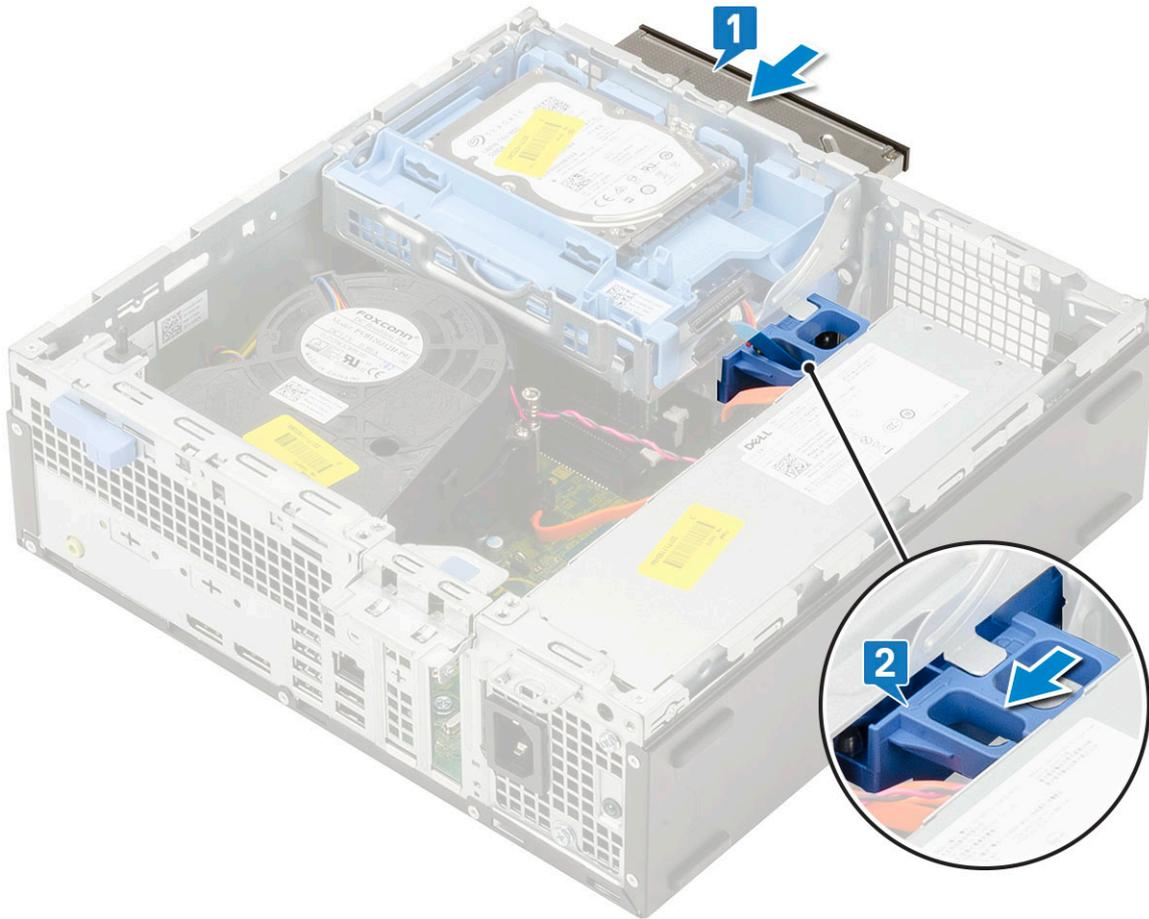
3. 提起硬盘驱动器和光盘驱动器模块 [1]，将光盘驱动器数据缆线和电源缆线连接到光盘驱动器上的连接器 [2、3]。
