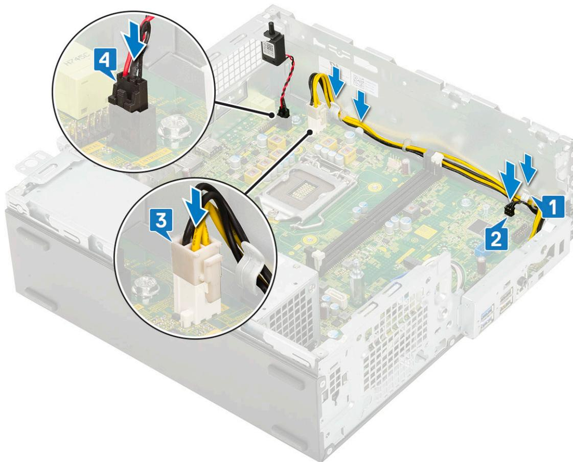
6. 连接电源线缆、光盘驱动器数据线缆和硬盘驱动器数据线缆 [1、2、3]。
