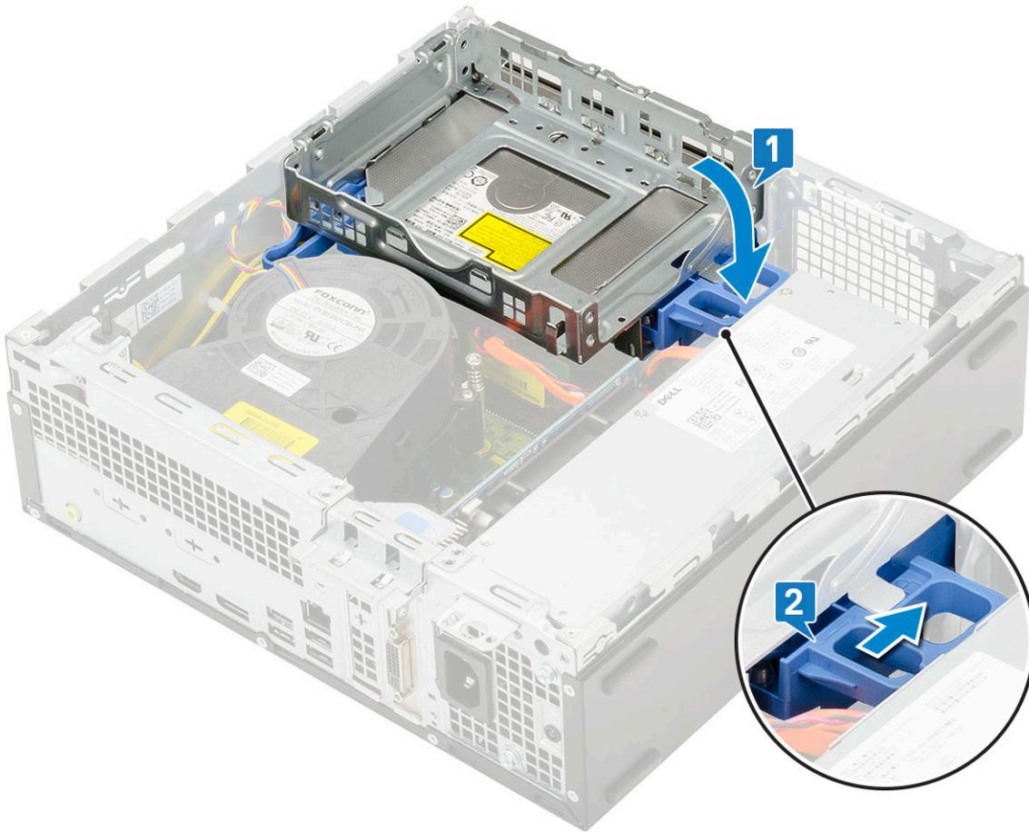
5. 穿过 HDD-ODD 释放卡舌布置硬盘驱动器数据和电源缆线 [1]。
