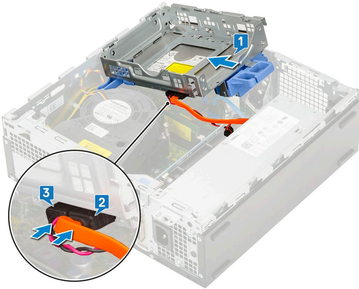
3. 向下放置硬盘驱动器和光盘驱动器模块，使其置于插槽中 [1]。
