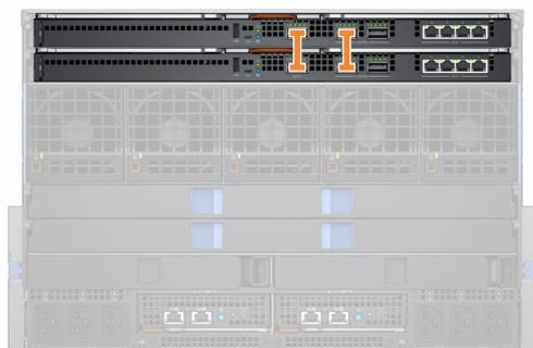
En mode SmartFabric, les ports 9 et 10 sont automatiquement configurés dans un VLT à une vitesse de 40GbE. Pour le port 10, utilisez un câble ou une optique qui prend en charge 40GbE et non 100GbE.
