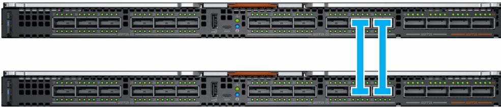
Pour le commutateur MX5108n, les ports 9 et 10 sont utilisés. Le port 10 fonctionne à 40 GbE au lieu de 100 GbE car toutes les liaisons VLT doivent s'exécuter à la même vitesse. Assurez-vous d'utiliser un câble ou une fibre optique prenant en charge 40GbE.
