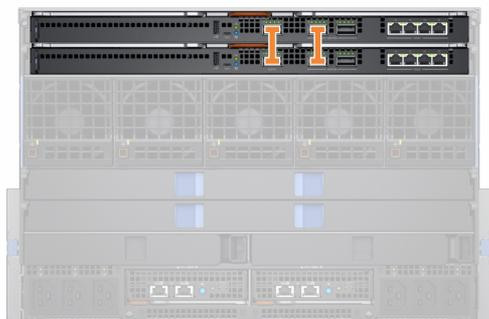
En modo SmartFabric, los puertos 9 y 10 se configuran automáticamente en un VLT a 40 GbE de velocidad. Para el puerto 10, use un cable o una óptica que admita 40 GbE y 100 GbE.
