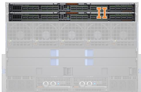
Se admite el diseño de Fabric "2 motores de switch de Fabric Mx9116n en el mismo chasis", pero no se recomienda. El uso de este diseño origina un mensaje de error en la **Topología de Fabric** y en las páginas **Ver topología** de OME - Modular.
