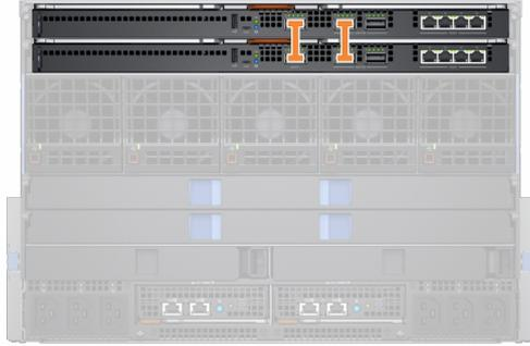
SmartFabric モードでは、ポート 9 および 10 は 40 GbE の速度の VLT で自動設定されます。ポート 10 には、100 GbE ではなく 40 GbE をサポートするケーブルまたは光ファイバーを使用してください。
