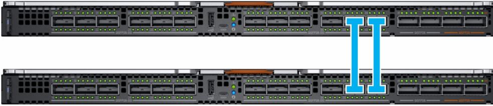
Para el MX5108n, se utilizan los puertos 9 y 10. El puerto 10 funciona a 40 GbE en lugar de 100 GbE, ya que todos los enlaces de VLT se deben ejecutar a la misma velocidad. Asegúrese de utilizar un cable o fibra óptica que admita 40 GbE.
