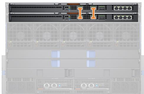
En modo SmartFabric, los puertos 9 y 10 se configuran automáticamente en un VLT a 40 GbE de velocidad. Para el puerto 10, use un cable o una óptica que admita 40 GbE y 100 GbE.
