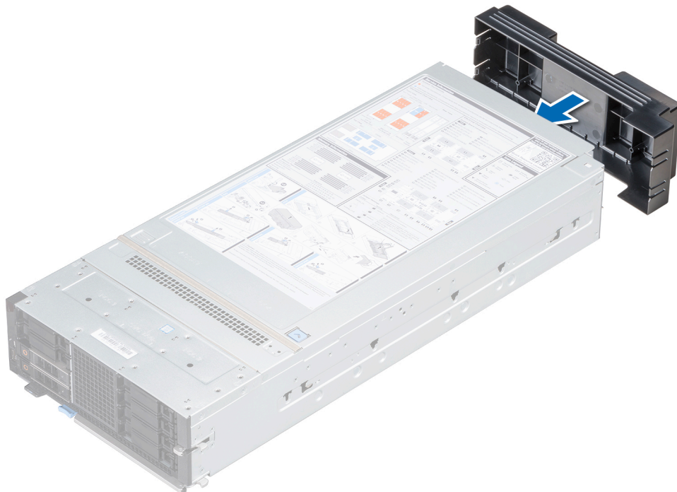
그림 14 . 슬레드에 I/O 커넥터 커버 설치
