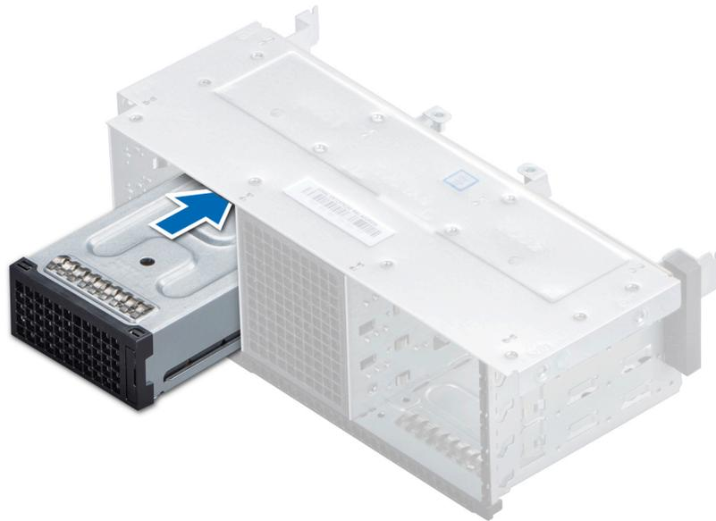
**Abbildung 46. Einbauen des BBU-Moduls**
