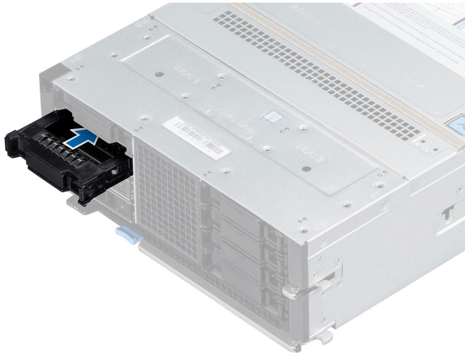
Abbildung 26. Einsetzen eines Laufwerkplatzhalters
