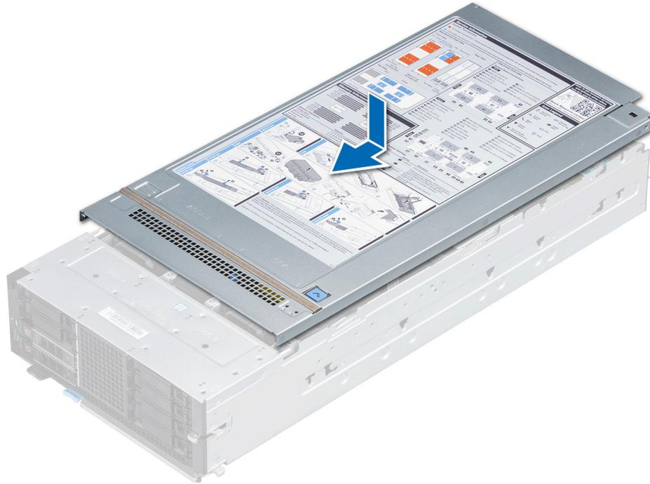
**Abbildung 18. Anbringen der Schlittenabdeckung**
