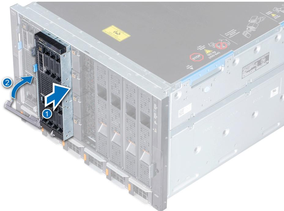
**Abbildung 16. Einsetzen des Schlittens in das Gehäuse**
