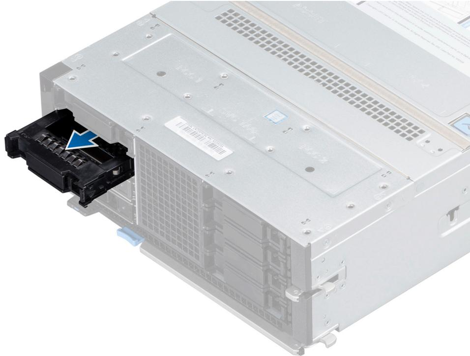
Abbildung 25. Entfernen eines Laufwerkplatzhalters
