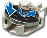
Abbildung 87. Installieren der Systembatterie
