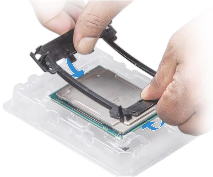
**Abbildung 58. Installieren der Prozessor-Halterung**
