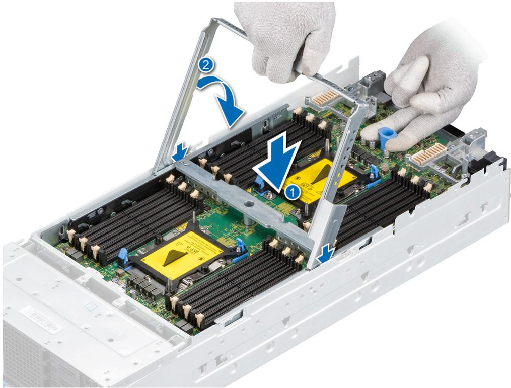
Abbildung 24. Einsetzen der PEM
