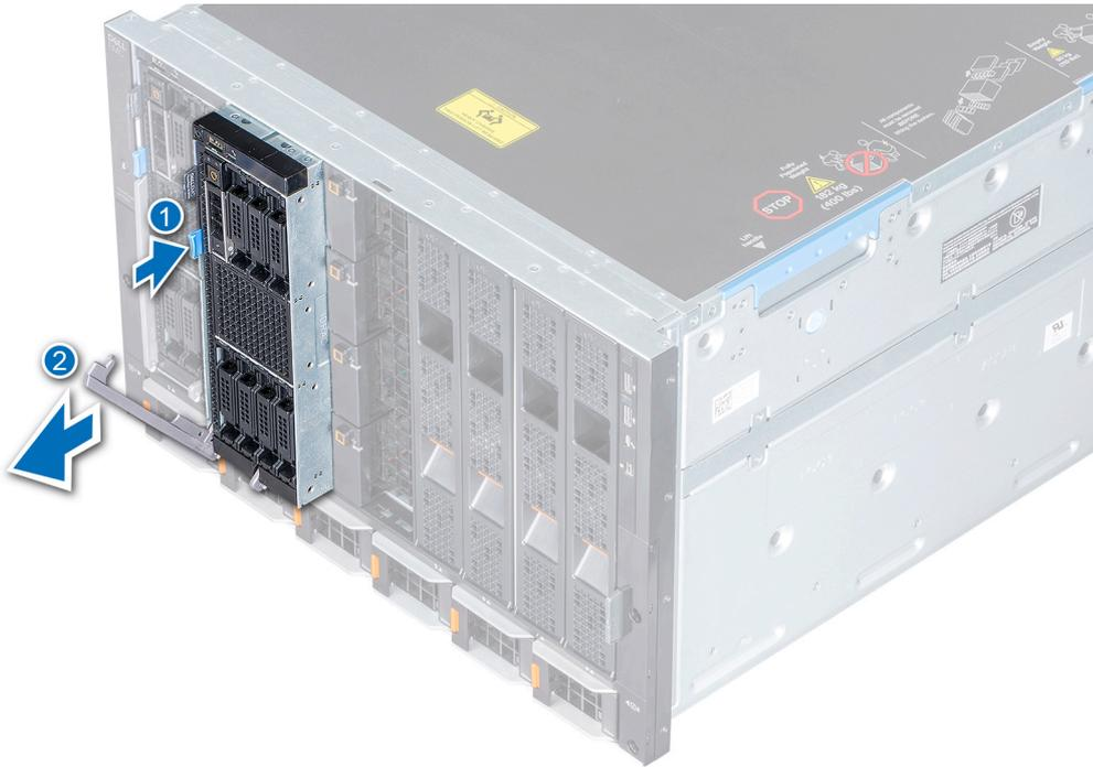
Abbildung 13. Entfernen des Schlittens aus dem Gehäuse
