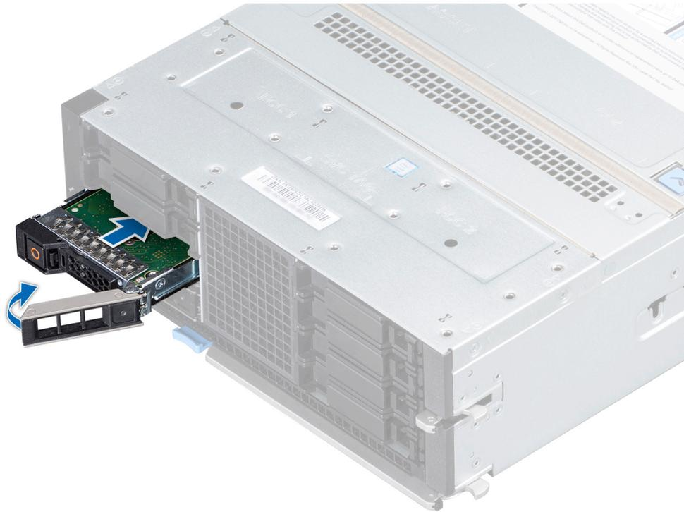
Abbildung 28. Einsetzen eines Laufwerksträgers
