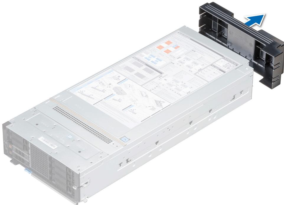
**Abbildung 15. Entfernen der E/A-Anschlussabdeckung vom Schlitten**
