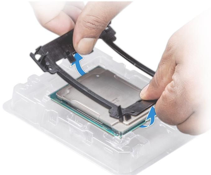
**Abbildung 57. Entfernen der Prozessorhalterung**
