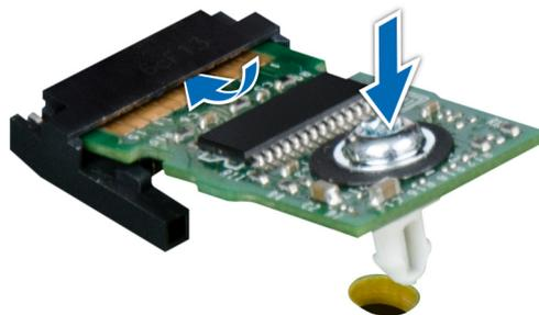
Abbildung 90. Installieren des TPM-Moduls
