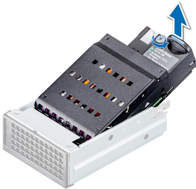
**Abbildung 47. Entfernen der BBU aus dem BBU-Träger**
