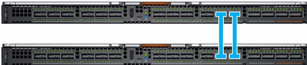
Für den MX5108n werden die Ports 9 und 10 verwendet. Port 10 arbeitet mit 40GbE anstelle von 100GbE, da alle VLT-Links mit der gleichen Geschwindigkeit laufen müssen. Stellen Sie sicher, dass Sie ein Kabel oder Glasfaserkabel verwenden, das 40GbE unterstützt.
