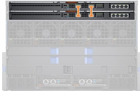
Im SmartFabric-Modus werden die Ports 9 und 10 automatisch in einem VLT mit 40 GbE Geschwindigkeit konfiguriert. Verwenden Sie für Port 10 ein normales oder optisches Kabel, das 40GbE und nicht 100GbE unterstützt.
