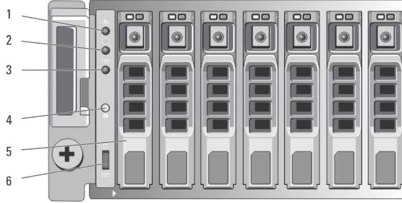
Rakam 2. Ön Panel Özellikleri ve Göstergeleri—Dell EMC PowerVault MD3820i
