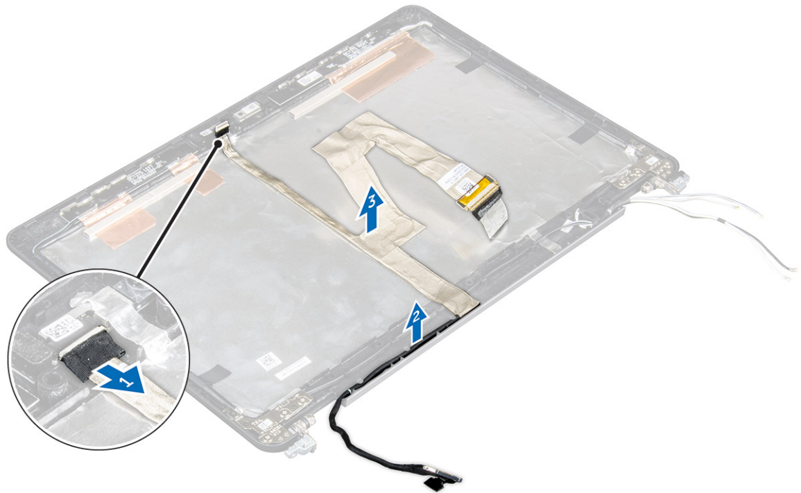
Figura 4. Como remover o cabo eDP para sistemas com tela sensível ao toque
