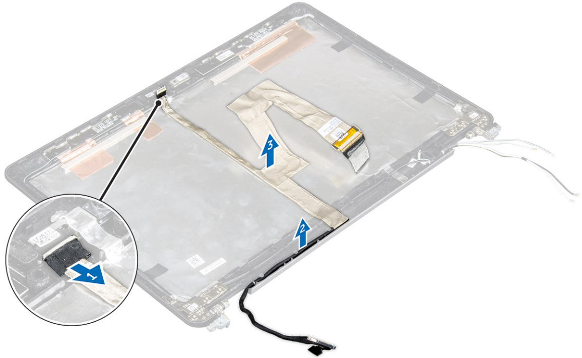
圖 4. 卸下觸控式系統的 eDP 纜線
