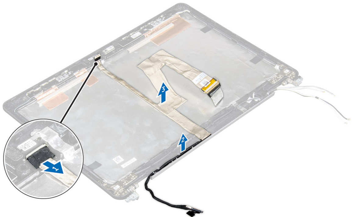
Figura 4. Scoaterea cablului eDP pentru sistemele cu ecran tactil
