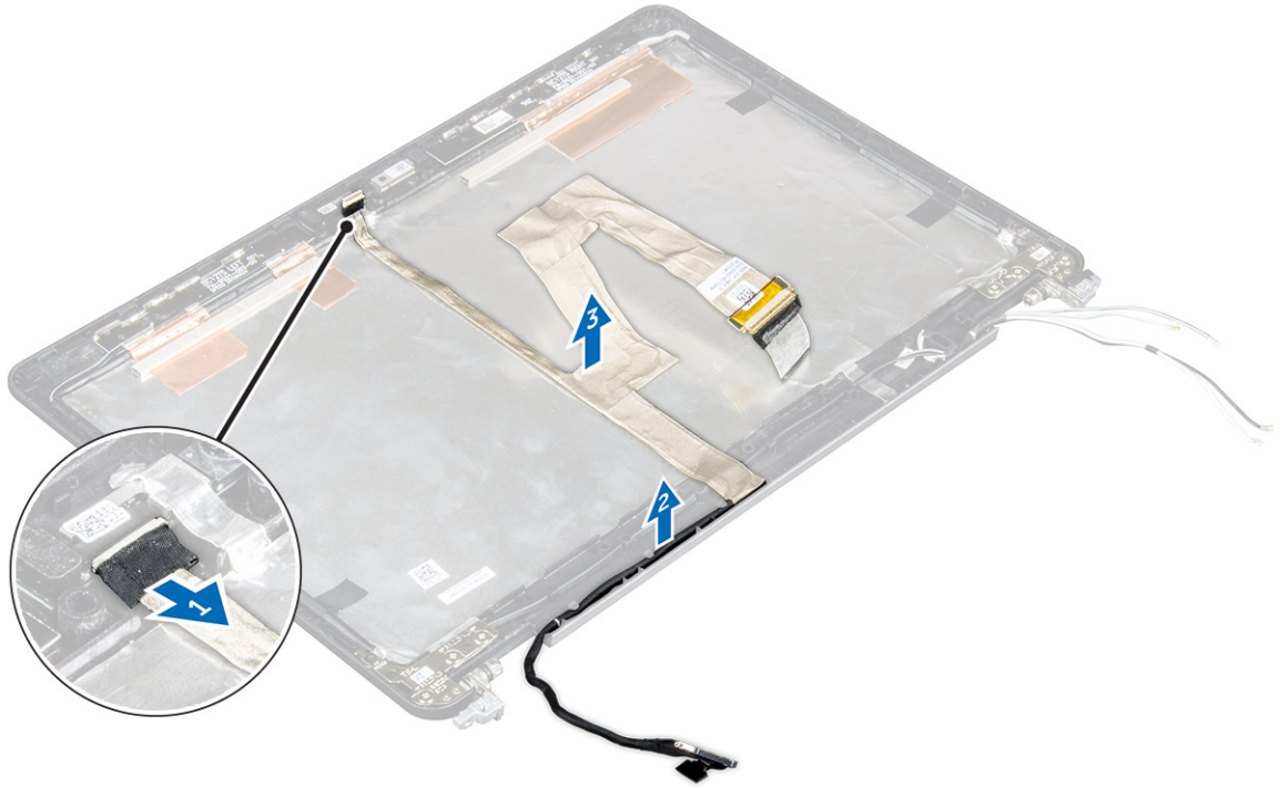
그림 4. 터치 시스템에서 eDP 케이블 분리
