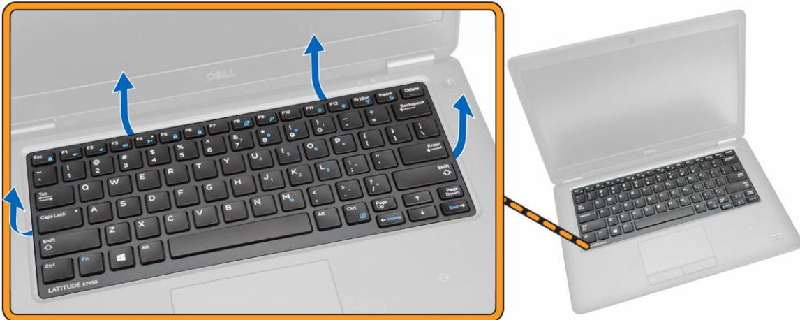
4. تم بإزالة حلية لوحة المفاتيح من لوحة المفاتيح.
