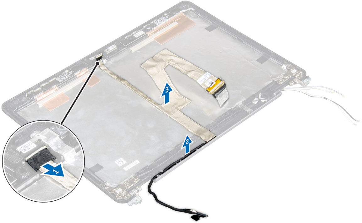
Rakam 4. Dokunmatik sistemlerde eDP kablosunu çıkarma
