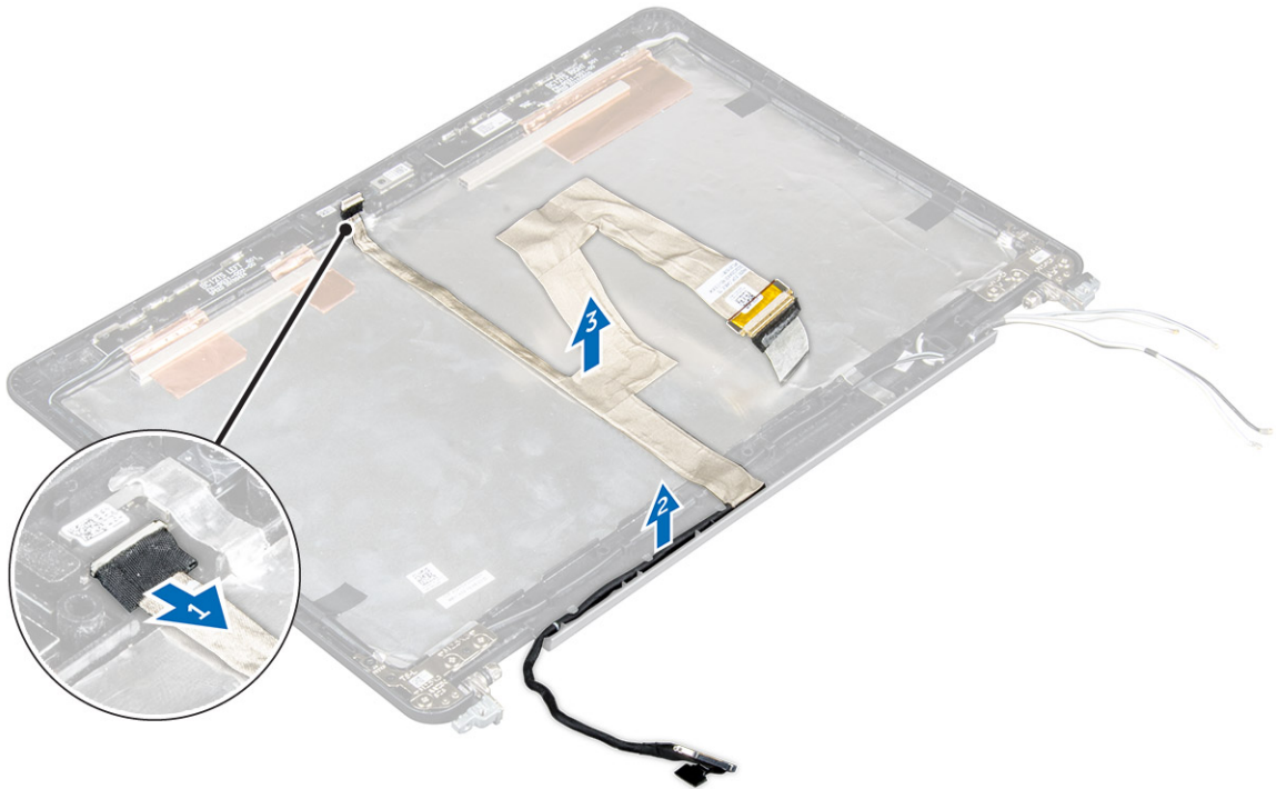
Rysunek 4. Wymywanie kabla eDP z komputera z ekranem dotykowym
