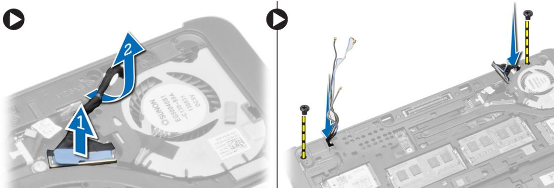
5. 卸下將顯示器組件固定在電腦上的螺絲，然後將顯示器組件從電腦抬起取出。
