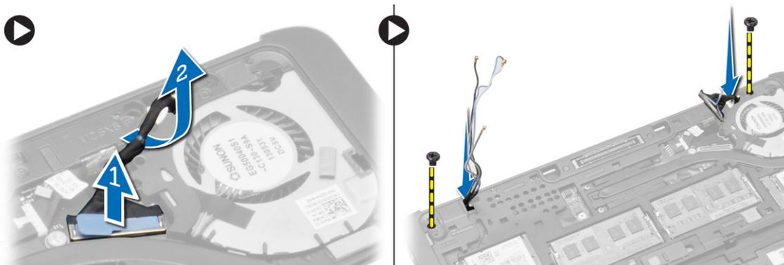
5. Entfernen Sie die Schrauben, mit denen die Bildschirmbaugruppe am Computer befestigt ist und heben Sie die Bildschirmbaugruppe aus dem Computer.
