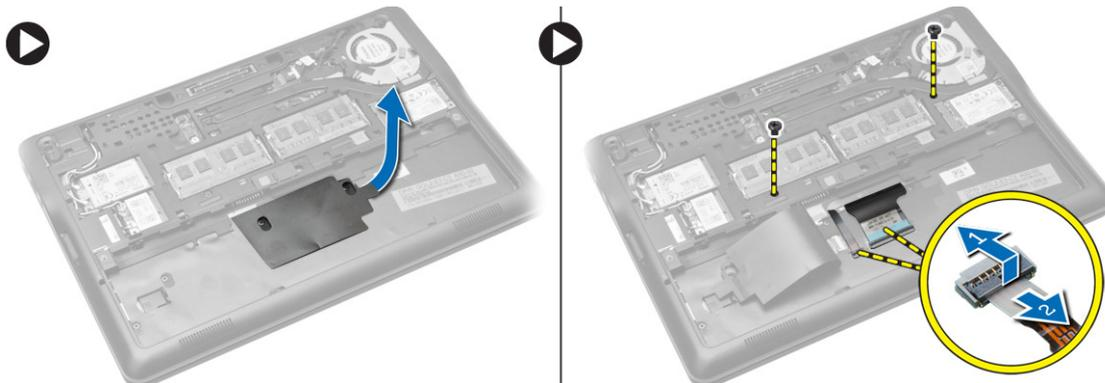
5. Drehen Sie den Computer um und entfernen Sie die Schrauben, mit denen die Tastatur am Computer befestigt ist.
