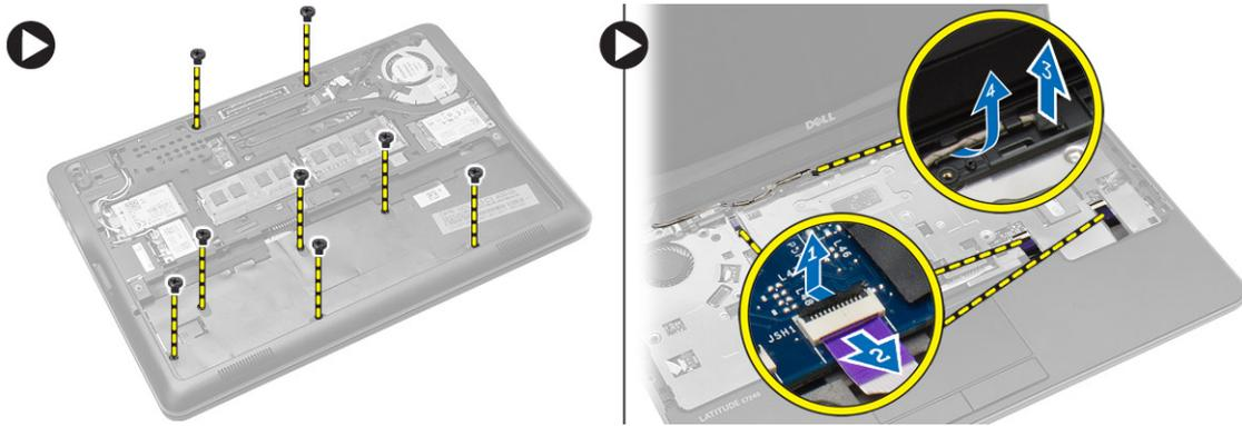
5. Entfernen Sie die Schrauben, mit denen die Handballenstützen-Baugruppe an der Computervorderseite befestigt ist. Heben Sie die Ränder an und heben Sie die Handballenstützen-Baugruppe vom Computer.
