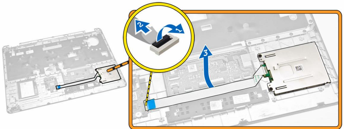
4. Lösen Sie die Platine des SmartCard-Lesegeräts. So lösen Sie die Platine des SmartCard-Lesegeräts:
