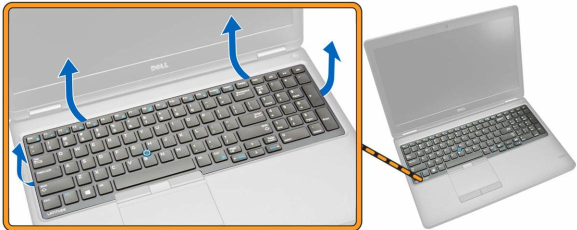
**ANMERKUNG:** Sie benötigen möglicherweise ein scharfes Werkzeug, um den Tastaturrahmen an den Kanten anzuhebeln.
