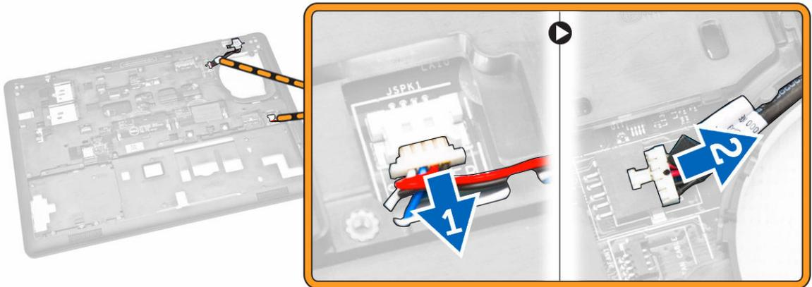
4. Trennen Sie das Kabel der Audioplatine [1] [2] und entfernen Sie die Schrauben, mit denen die Systemplatine am Computer befestigt ist [3].
