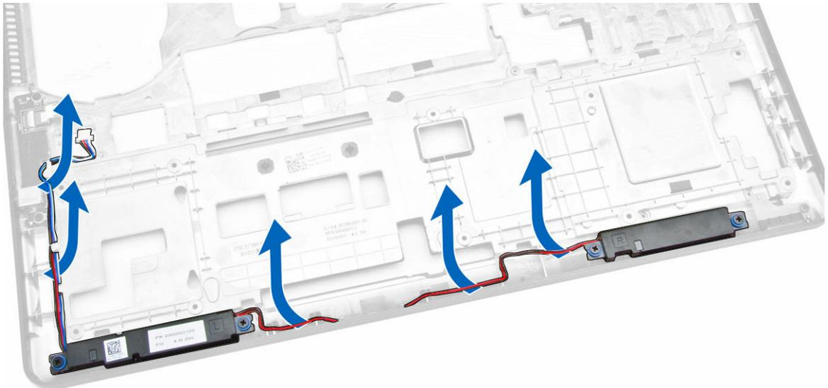
4. Führen Sie folgende Schritte durch, um die Lautsprecher aus dem Computer zu entfernen:
