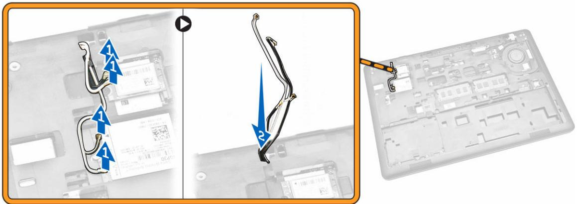
4. Trennen Sie das Bildschirmkabel von der Systemplatine. So trennen Sie das Bildschirmkabel:
