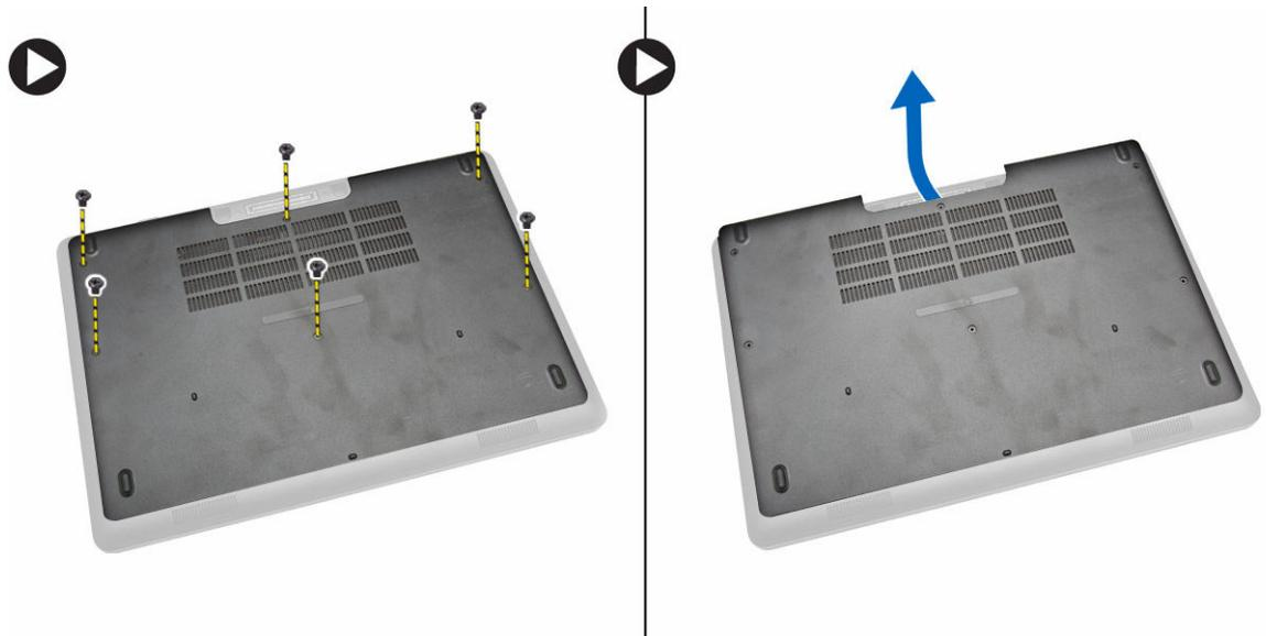
**ANMERKUNG:** Sie benötigen möglicherweise ein scharfes Werkzeug, um die Bodenabdeckung an den Kanten anzuhebeln.
