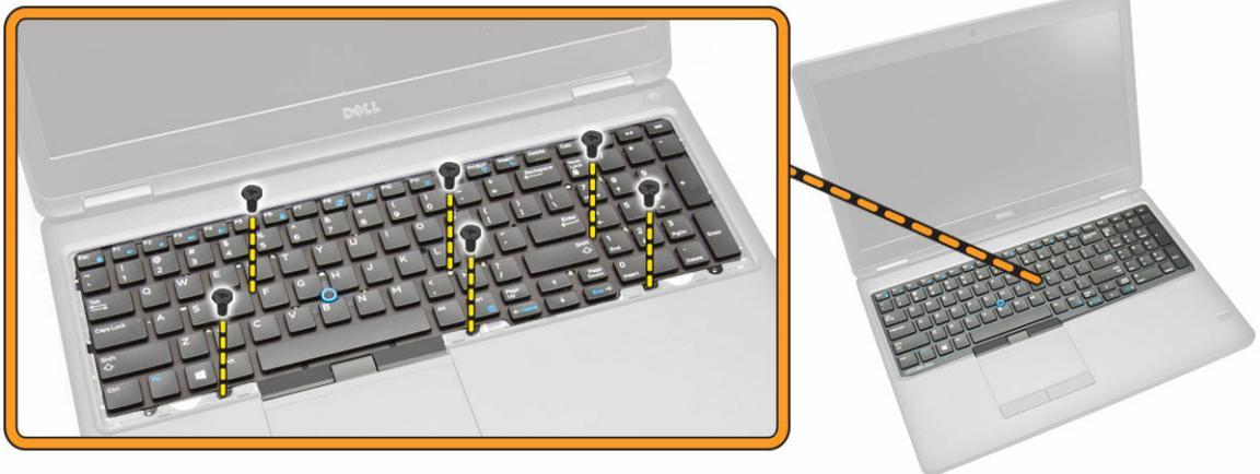
5. Entfernen Sie die Tastatur aus dem Computer.
