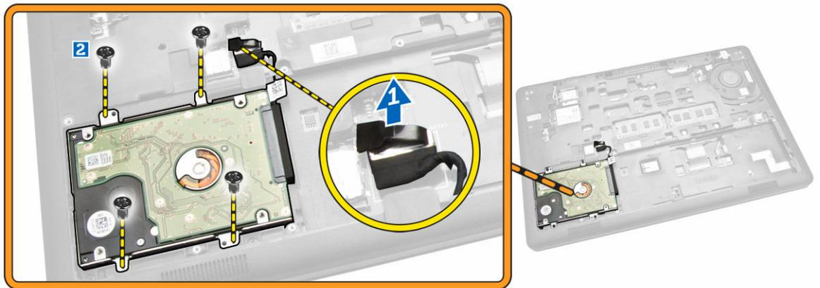
4. Entfernen Sie die Festplattenlaufwerksbaugruppe aus dem Computer.
