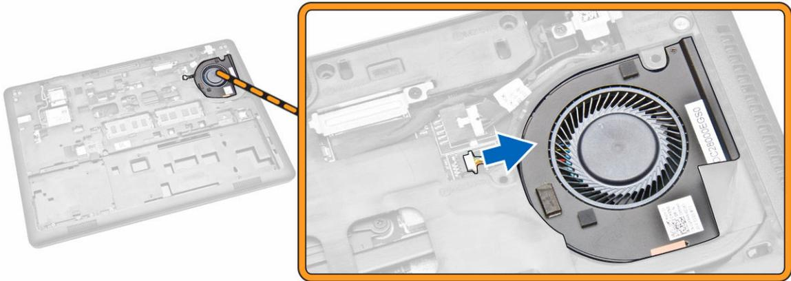
4. Entfernen Sie den Systemlüfter aus dem Computer.
