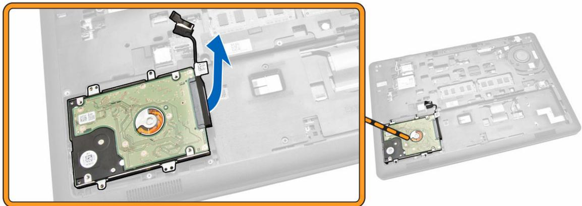
5. Ziehen Sie, um das Festplattenlaufwerkkabel von seinem Anschluss zu lösen.
