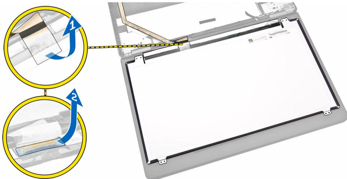
5. Trennen Sie das eDP-Kabel von seinem Anschluss [1] und entfernen Sie den Bildschirm von der Bildschirmbaugruppe [2].
