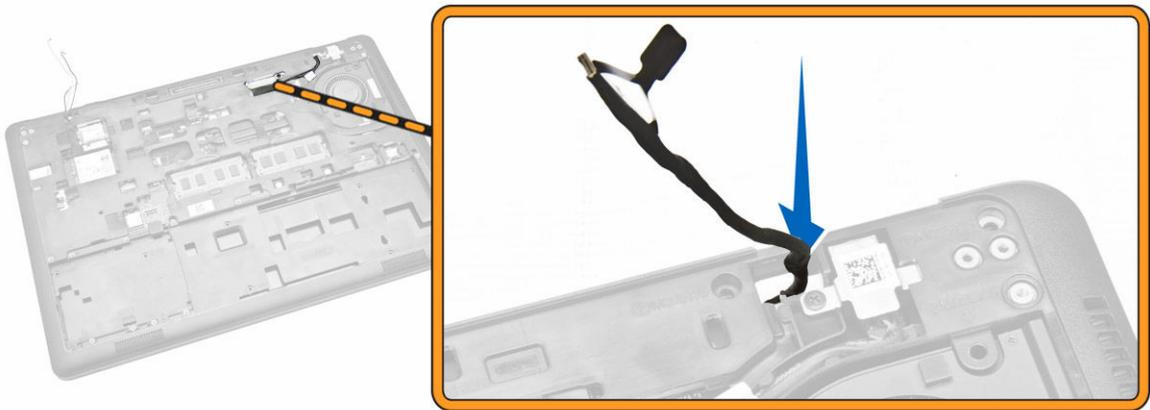
6. Entfernen Sie die Schrauben, mit denen die Bildschirmbaugruppe befestigt ist [1], und heben Sie die Bildschirmbaugruppe an und entfernen Sie sie aus dem Computer [2].
