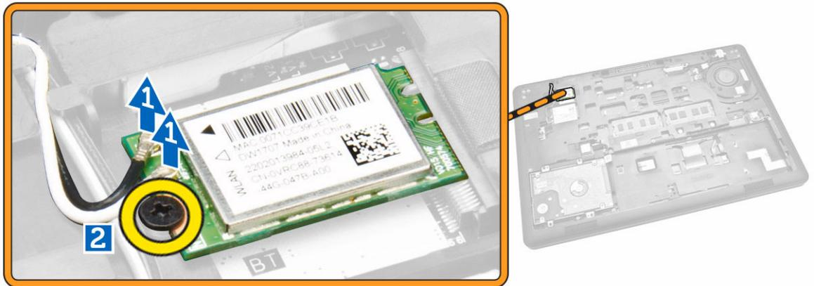
4. Entfernen Sie die WLAN-Karte aus dem Computer.
