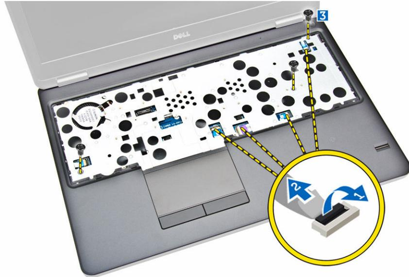
5. Drücken Sie auf die Handballenstütze, um sie zu lösen und vom Computer zu entfernen [2].
