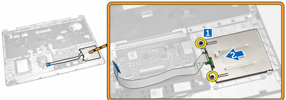
5. Entfernen Sie die Platine des SmartCard-Lesegeräts von der Handballenstütze.
