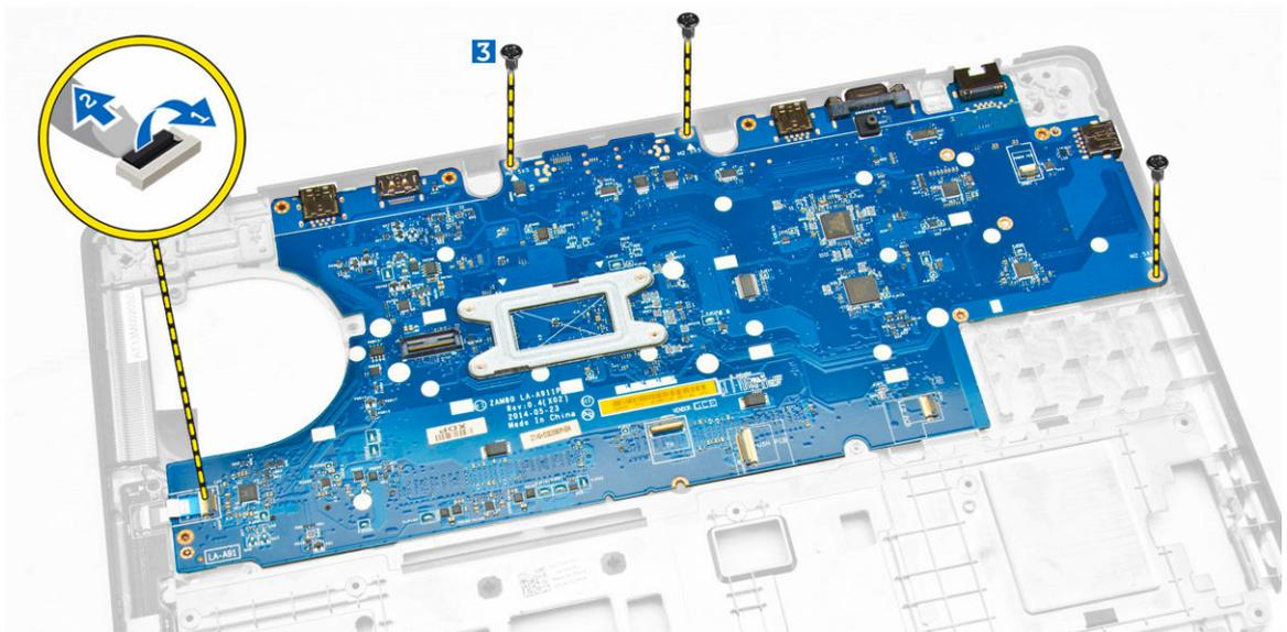
5. Entfernen Sie die Systemplatine aus dem Gehäuse.
