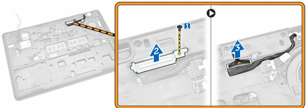
5. Lösen Sie das Bildschirmkabel aus der Kabelführung.
