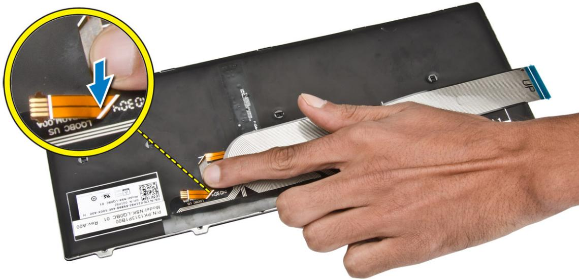
6. Conecte el cable del teclado a su conector en la placa base.
