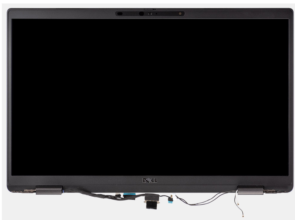
Rysunek 5. Zestaw wyświetlacza z kablami antenowymi sieci WLAN i WWAN
