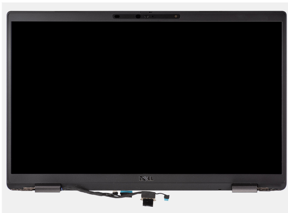
Rysunek 1. Zestaw wyświetlacza bez kabli antenowych
