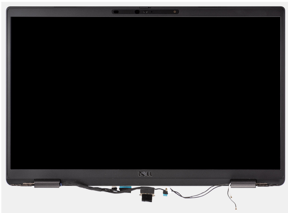
그림 5. WLAN 및 WWAN 안테나 케이블이 있는 디스플레이
