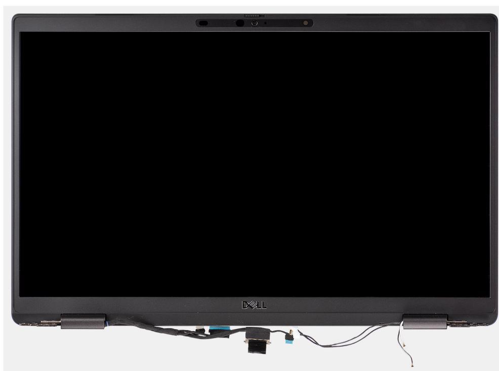
Figura 5. Gruppo del display con cavi dell'antenna WLAN e WWAN
