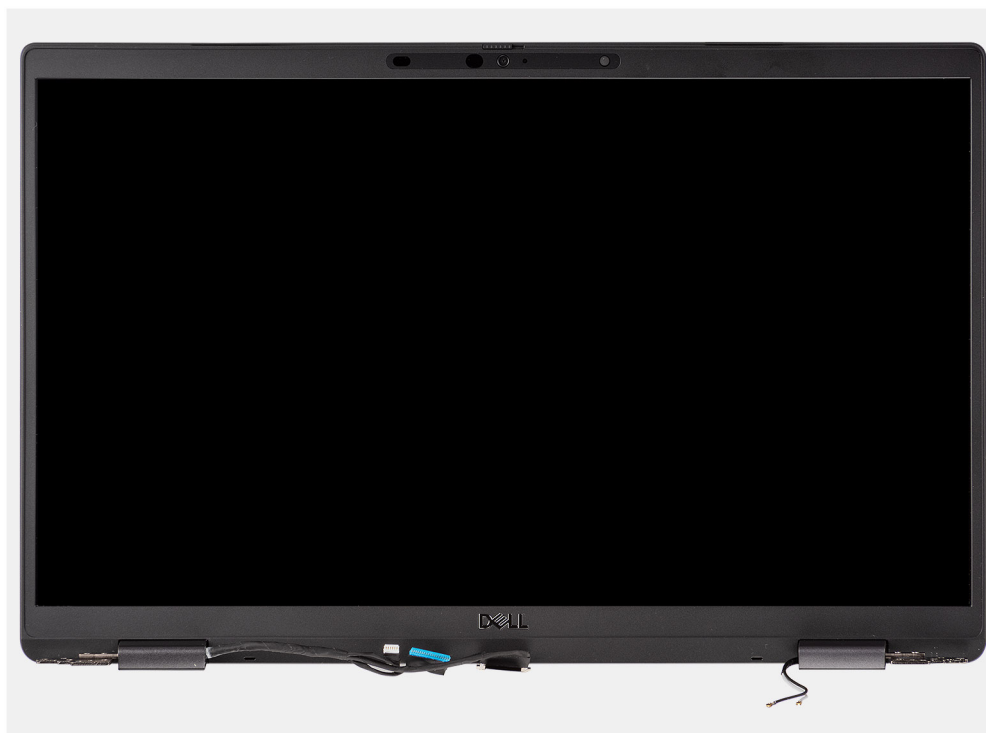
Figura 4. Gruppo del display con cavi dell'antenna
