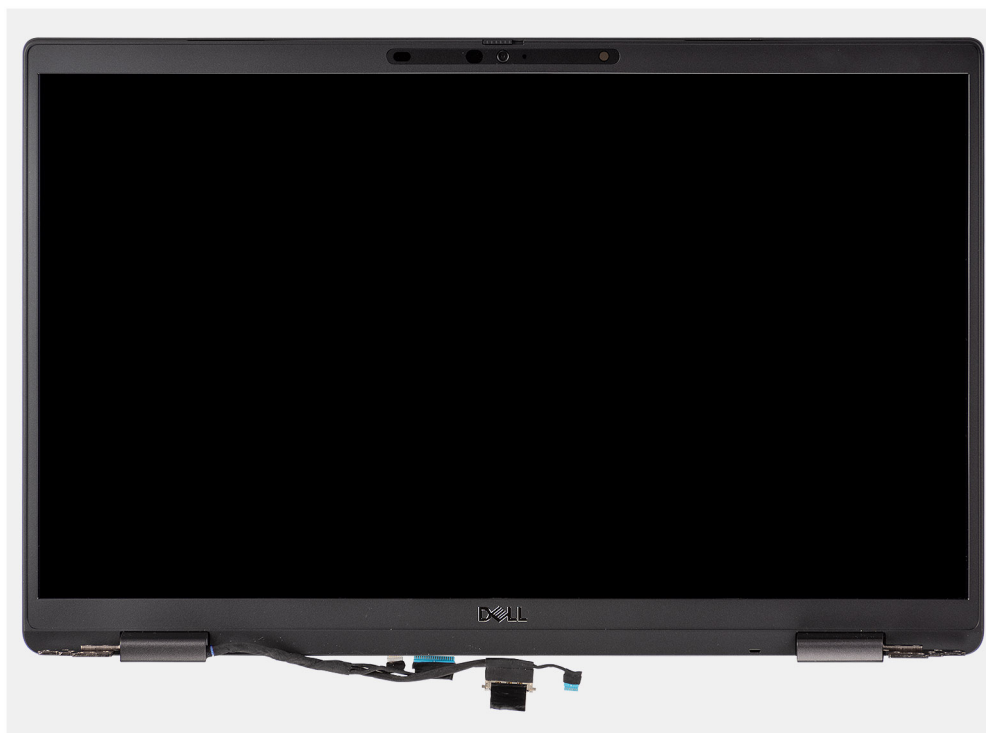
Joonis 1. Antennikaabliteta ekraanimoodul
