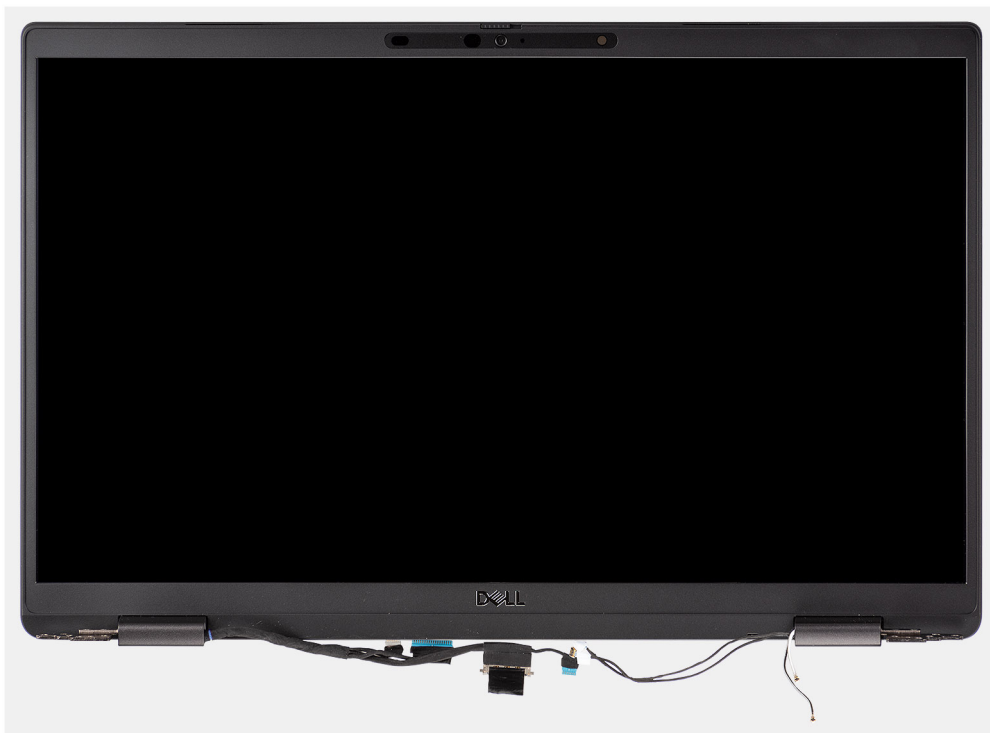
Joonis 5. WLAN- ja WWAN-antennikaablitega ekraanimoodul
