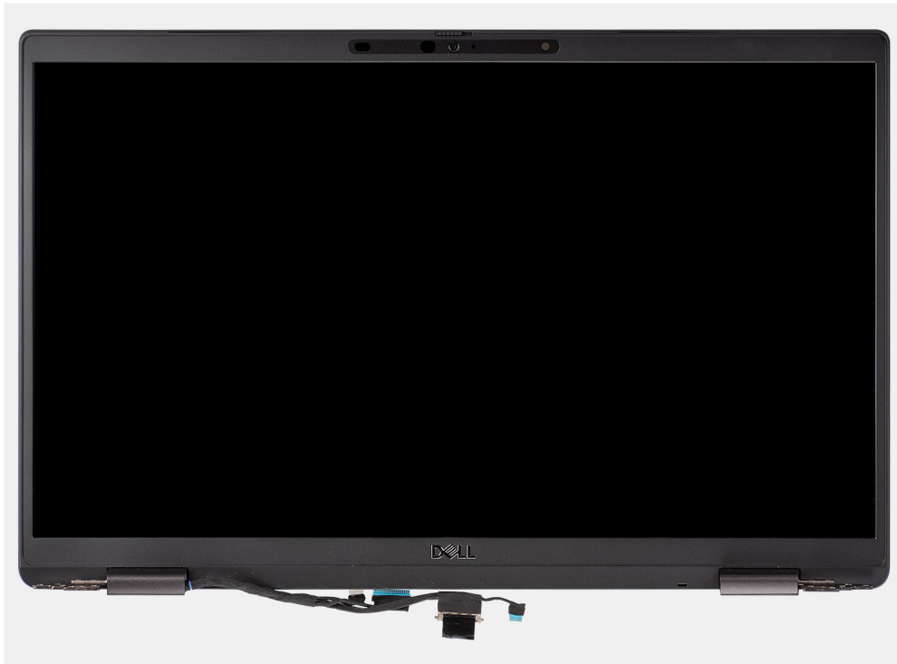
Ilustración 1. Ensamblaje de la pantalla sin cables de la antena
