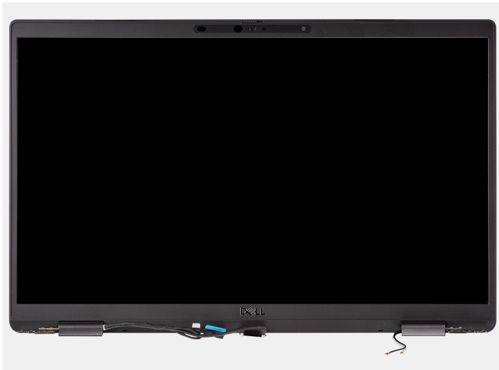
Abbildung 4. Bildschirmbaugruppe mit Antennenkabeln
