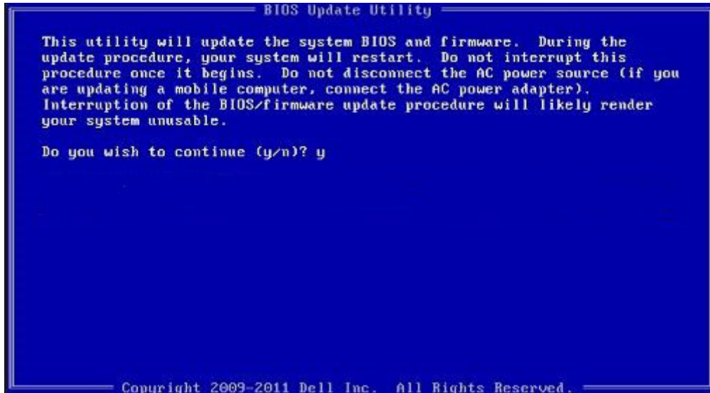
Figura 4. Schermata di aggiornamento del BIOS in DOS
