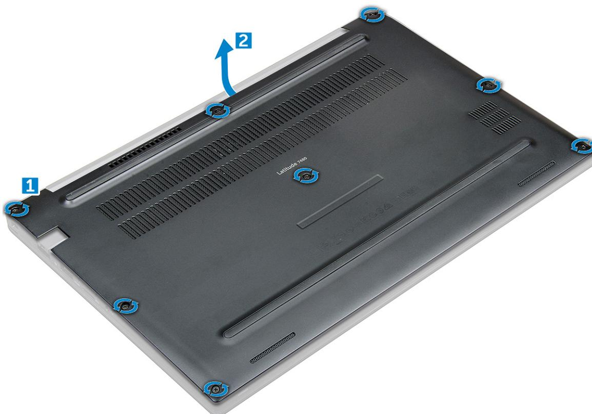
**PRÉCAUTION :** Faites preuve de prudence lorsque vous desserrez les vis. Inclinez le tournevis pour le placer sur la tête de vis (coins avant sur le cache de fond de l'ordinateur portable) pour éviter de décaper la tête de vis.
