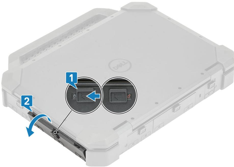
3. SIM カードをシステム ボードのスロットに挿入し [1]、SIM カード スロットに SIM カバー ロックをセットします [2]。
