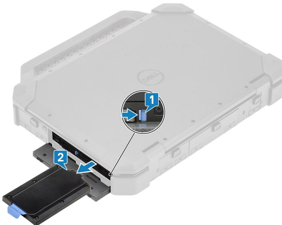
4. **メモ:** システムには、オーダーされた構成に応じて、キャリア内にハードドライブまたはソリッドステートドライブが搭載されている場合があります。取り付けおよび取り外しの手順は同じです。
