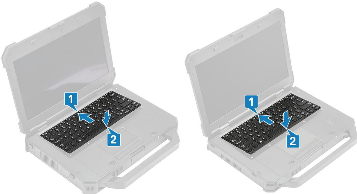
6. 「M2.5\*5」ネジ 6 本をキーボードに取り付け、コンピューターに固定します。
