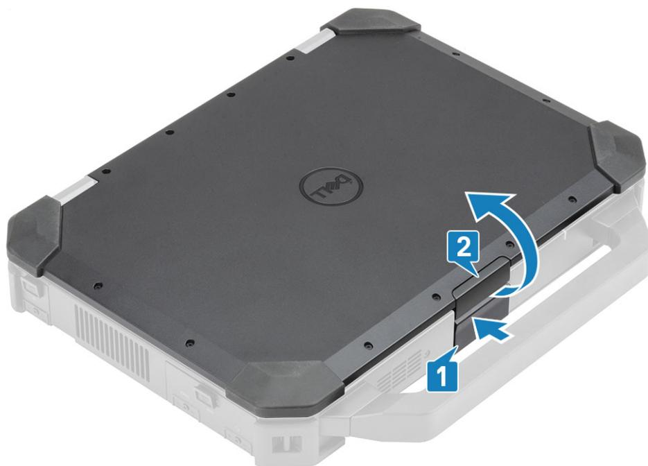
5. LCD の蓋を鈍角に傾けて持ち、背面からヒンジ カバーを押ししてコンピューターから取り外します。
