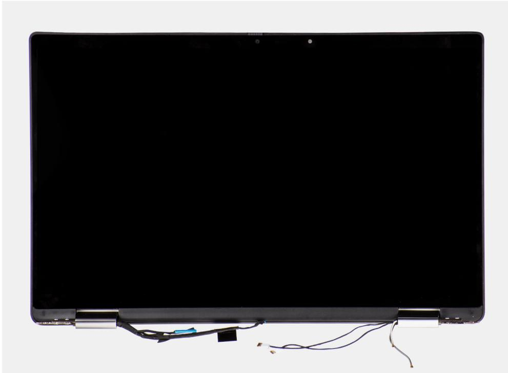
Figure 5. Assemblage d'écran avec câbles d'antenne
