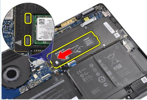
Remettez en place la plaque thermique SSD sur la partie supérieure du disque SSD et fixez-la à l'aide de la vis unique M2x2 sur la carte système.
