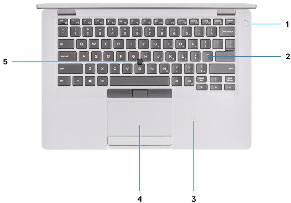
1. 电源按钮，带可选的指纹读取器
