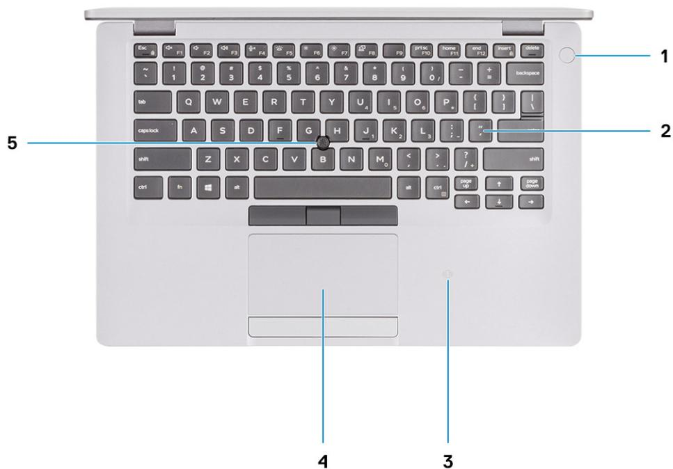
1. Кнопка питания с дополнительным устройством считывания отпечатков пальцев
