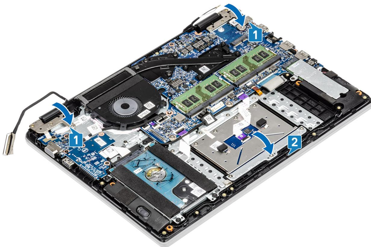
4. Recoloque os seis parafusos (M2.5x5) que prendem as dobradiças esquerda e direita à placa de sistema, e o apoio para as mãos e o conjunto do teclado [1].
