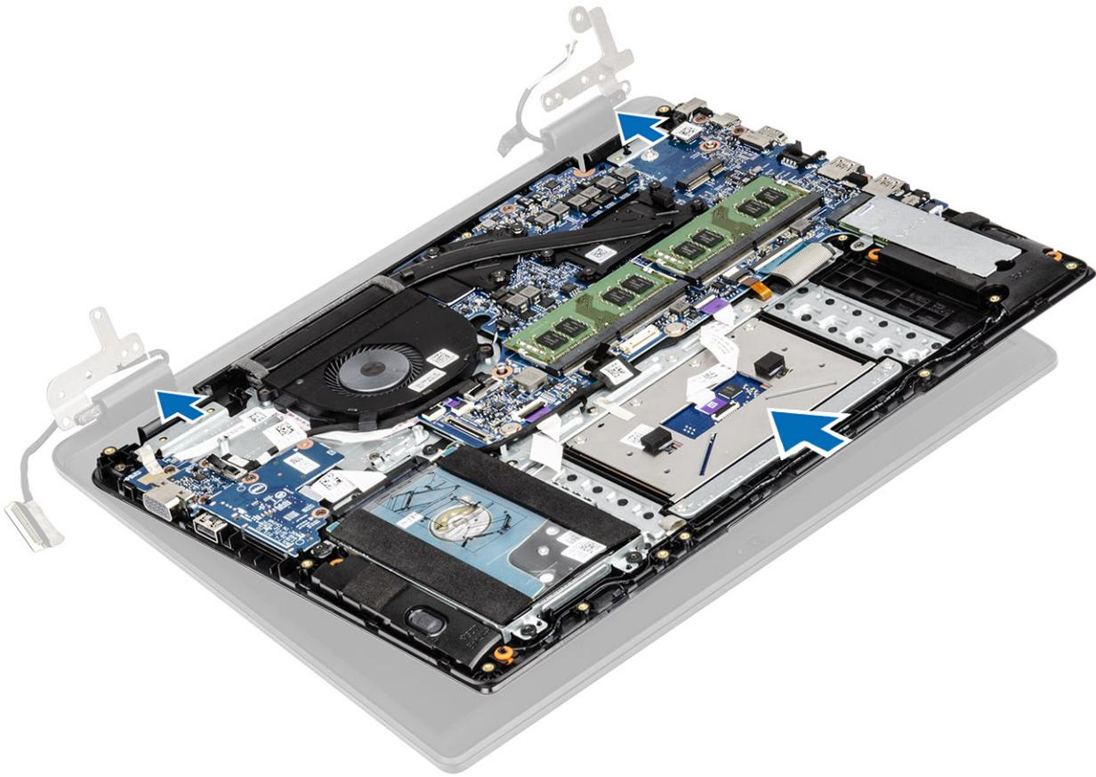
2. Pressione as dobradiças na placa de sistema e no conjunto do apoio para as mãos e teclado [1].
