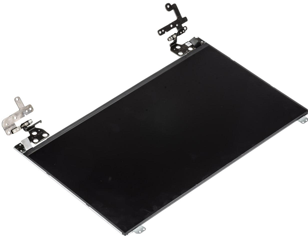
2. Conecte o cabo de vídeo no respectivo conector na parte traseira do painel da tela e feche a trava para prender o cabo [1].
