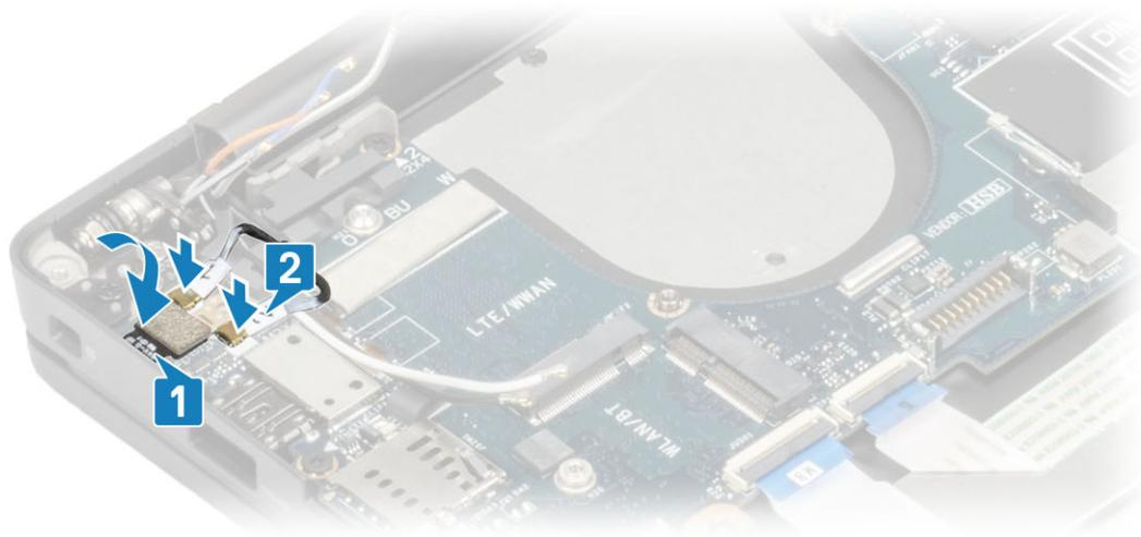
11. Encaminhe o cabo da coluna através da guia [1] ao lado da placa secundária de LED e ligue-o à placa de sistema [2].
