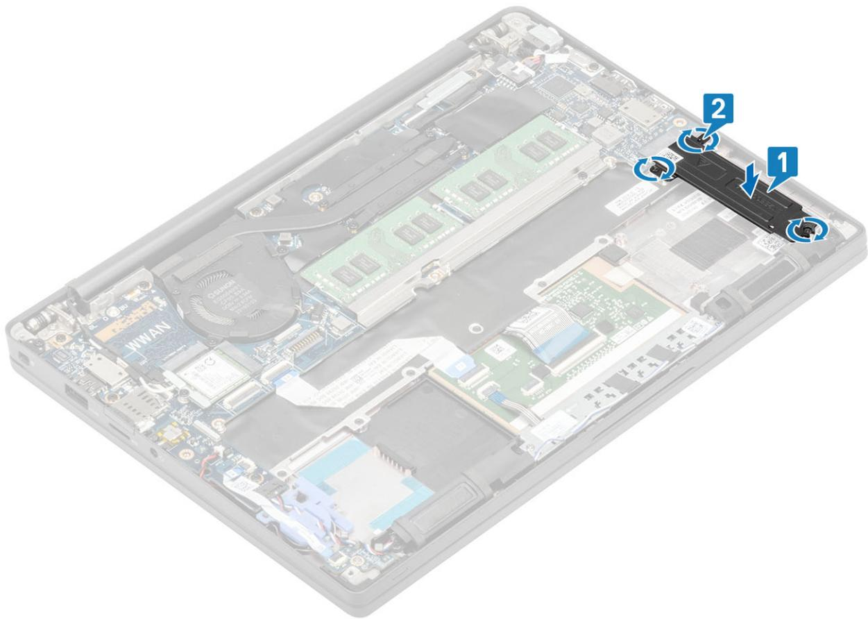
**NOTA:** Este procedimento ilustra uma SSD M.2 2280. A SSD M.2 2230 exige um suporte especial e uma placa para fixá-la ao conjunto do descanso para as mãos.
