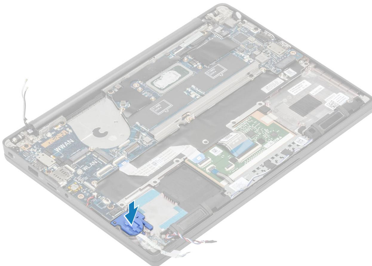
9. Ligue o cabo do botão de alimentação (com leitor de impressões digitais) à placa de sistema [1].
