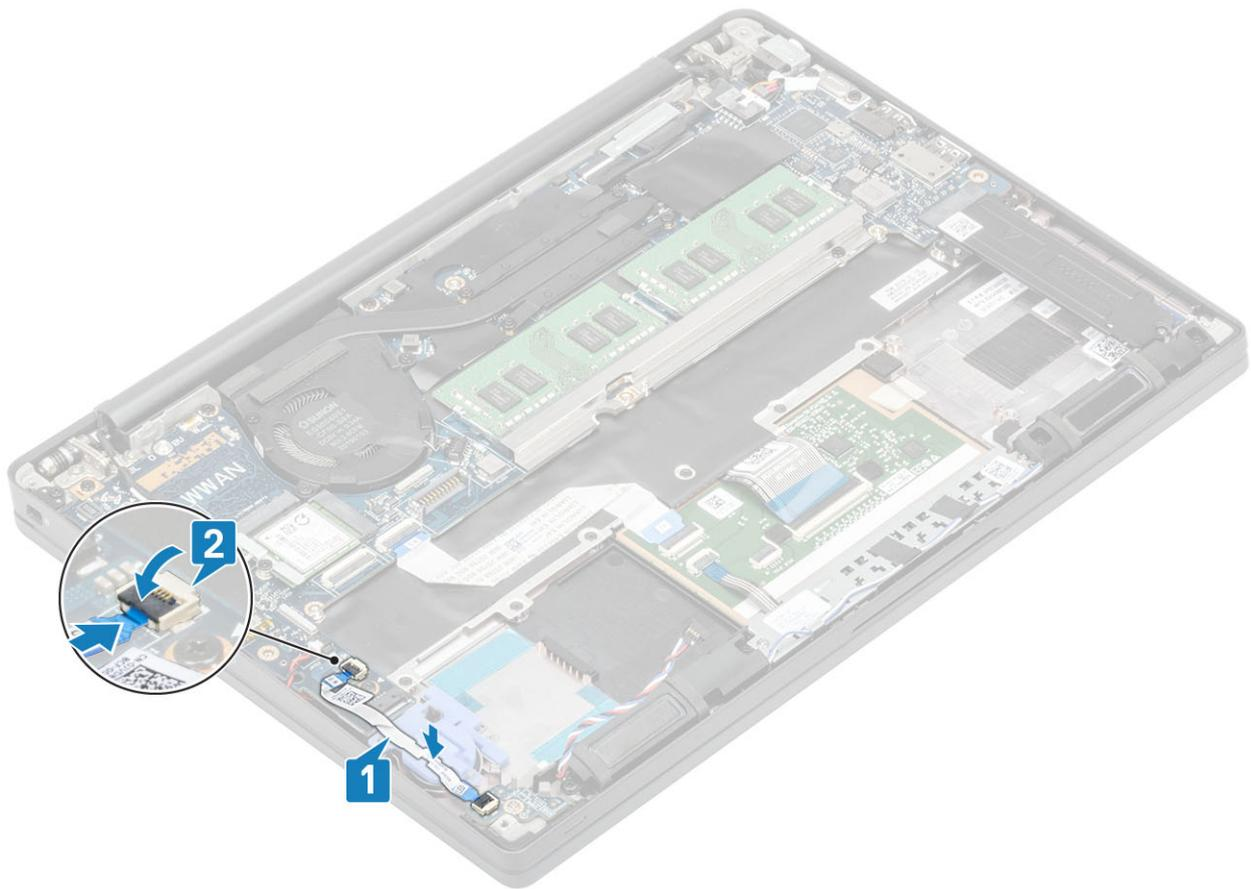
**AVISO:** Encaminhe o cabo da coluna [1] por cima da placa secundária de LED e, em seguida, ligue-o à placa de sistema [2] para prevenir danos aos cabos das colunas.
