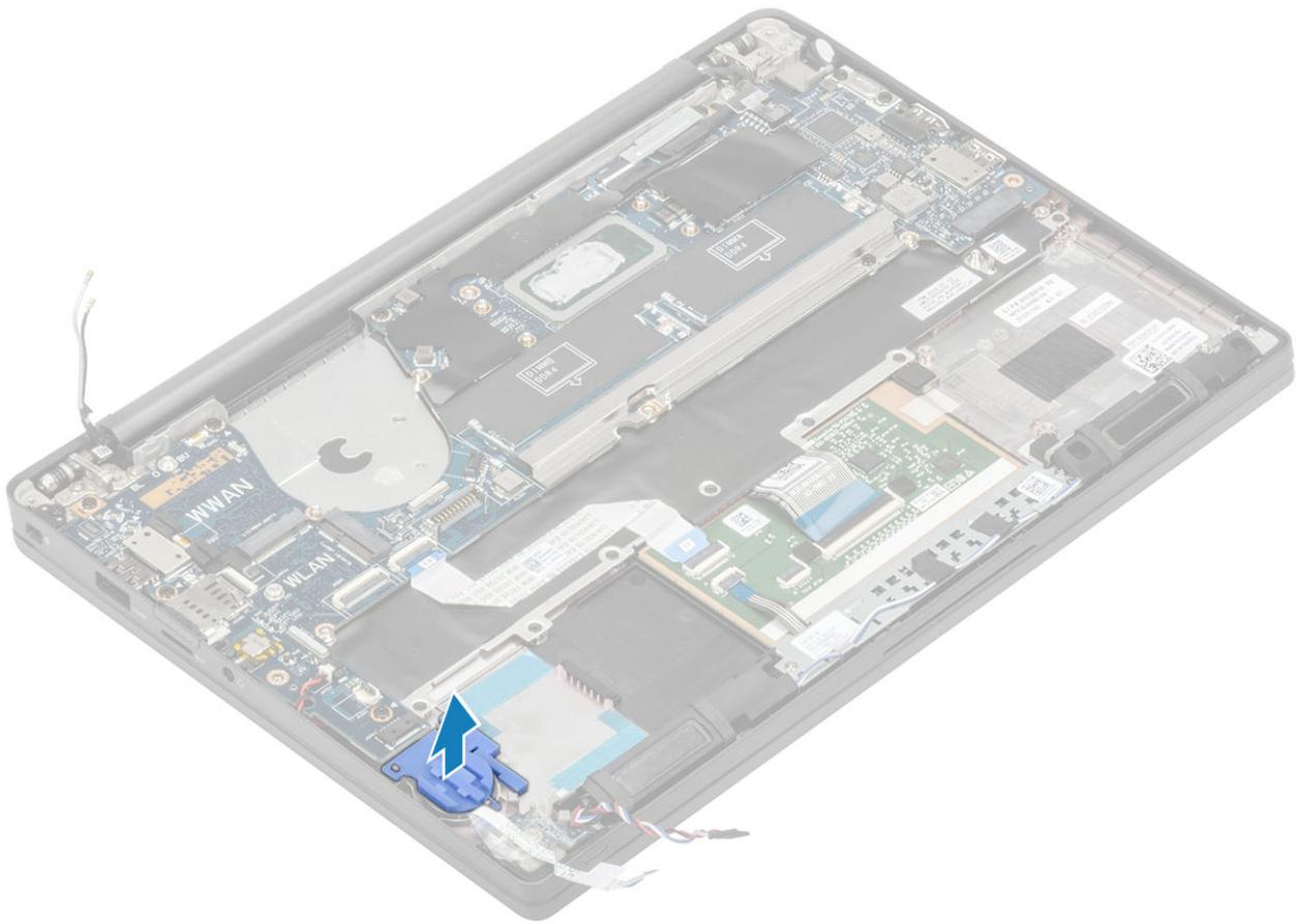
6. Retire o parafuso (M2x3) único do suporte do cabo do ecrã [1] e remova-o da placa de sistema [2].
