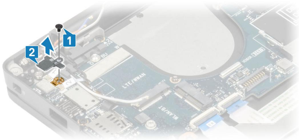
11. Retire o cabo do botão de alimentação (com leitor de impressões digitais) da placa de sistema [1].
