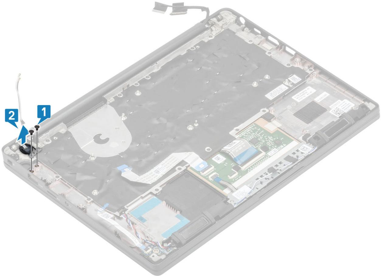
**Figura3. Placa do botão de alimentação sem FPR**
