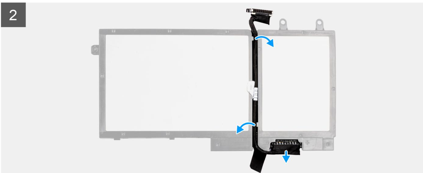
1. Descole a fita adesiva que fixa o cabo da bateria à própria bateria.
