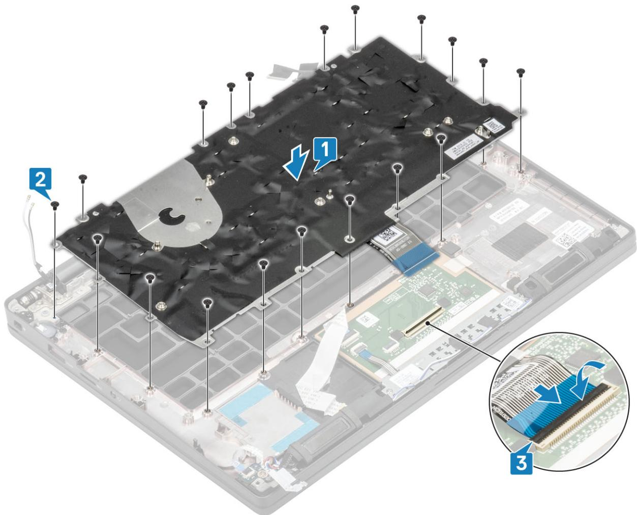
**NOTA:** Os teclados retroiluminados têm um cabo extra da retroiluminação que tem de ser ligado ao módulo da mesa sensível ao toque.
