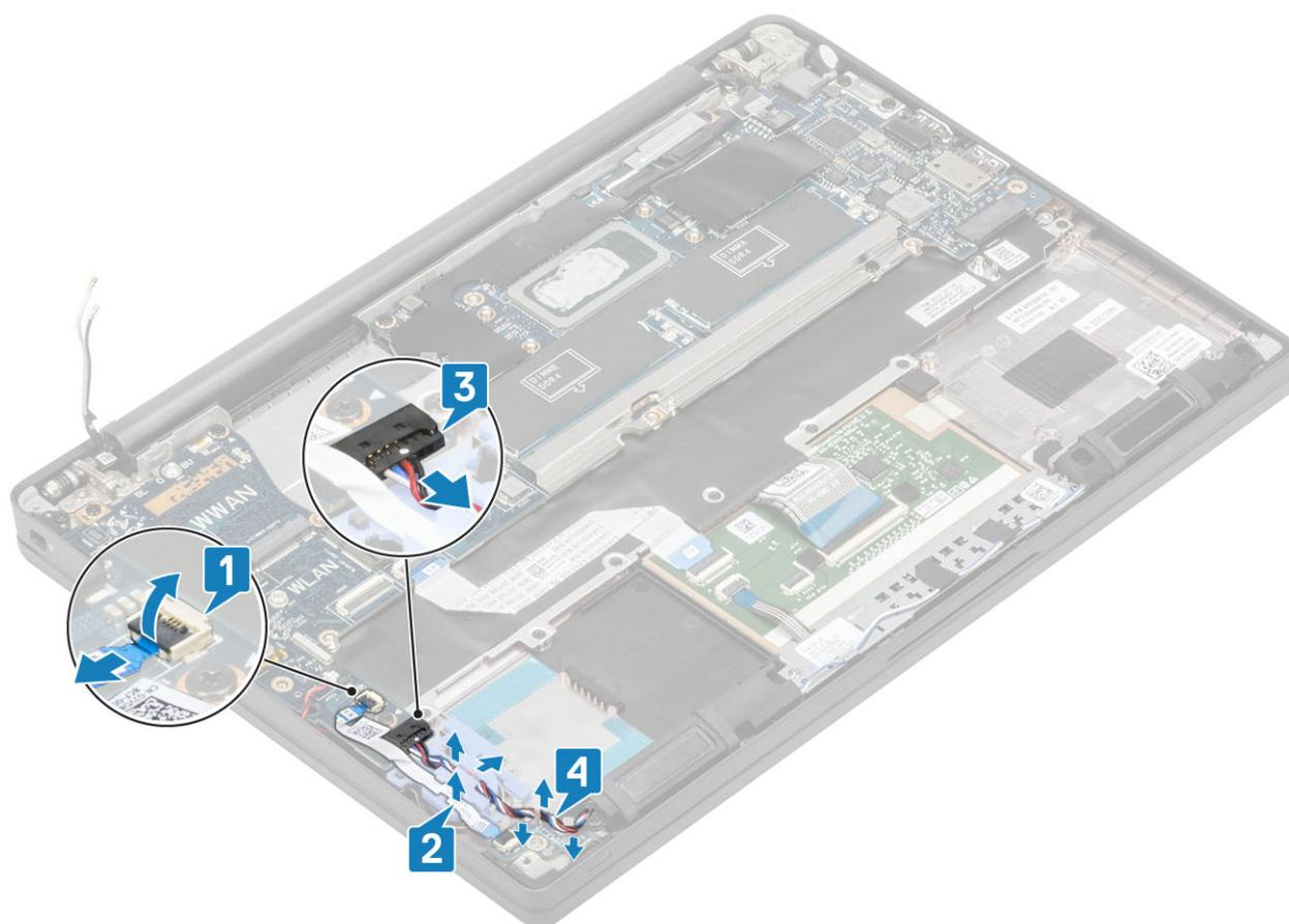
5. Retire o canal de encaminhamento de borracha da bateria de célula tipo moeda.
