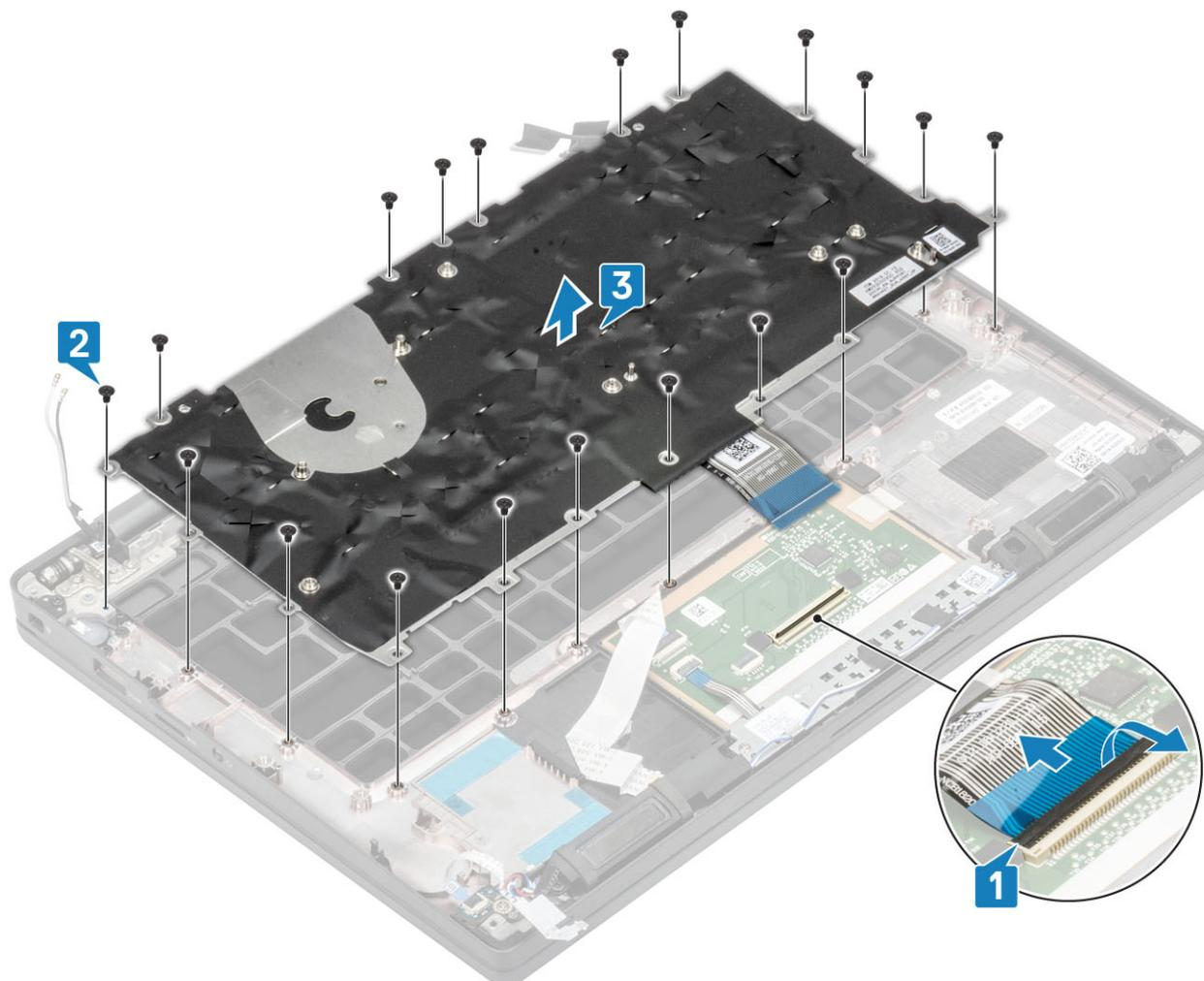
3. Retire os dois parafusos (M2x2) [1] para levantar o teclado da chapa de suporte do teclado.
