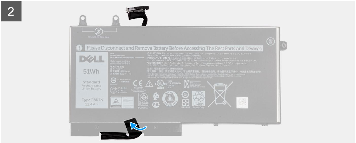
1. Alinhe e coloque o cabo da bateria na bateria.
