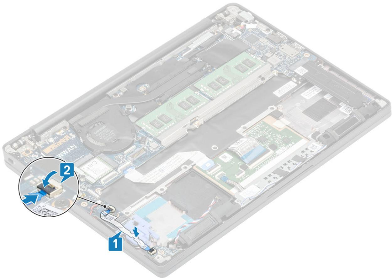
**⚠ CUIDADO:** Passe o cabo do alto-falante [1] pela placa filha de LED e, em seguida, conecte-o à placa de sistema [2] para evitar danos aos cabos do alto-falante.
