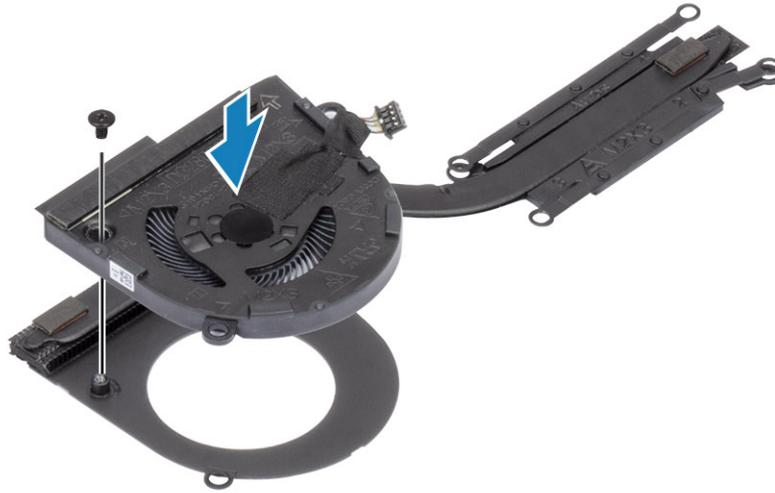
2. Coloque o conjunto do ventilador do dissipador de calor no computador [1].
