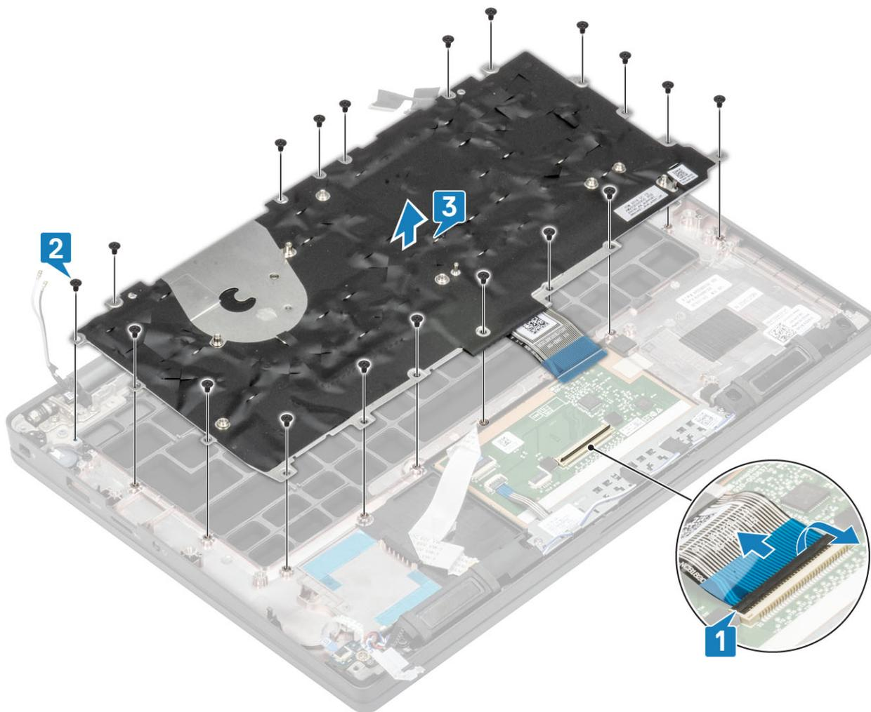
3. Remova os dois parafusos (M2x2) [1] para levantar o teclado de sua placa de suporte.
