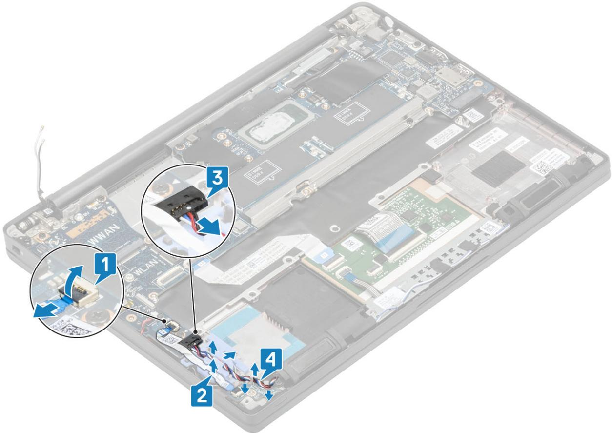
5. Retire o canal de roteamento de borracha da célula tipo moeda.
