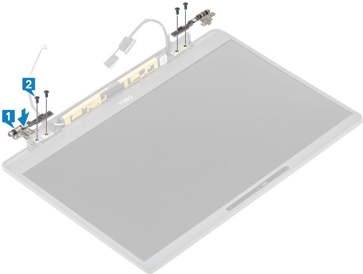
3. Passe a antena e o cabo da tela ao longo das dobradiças.
