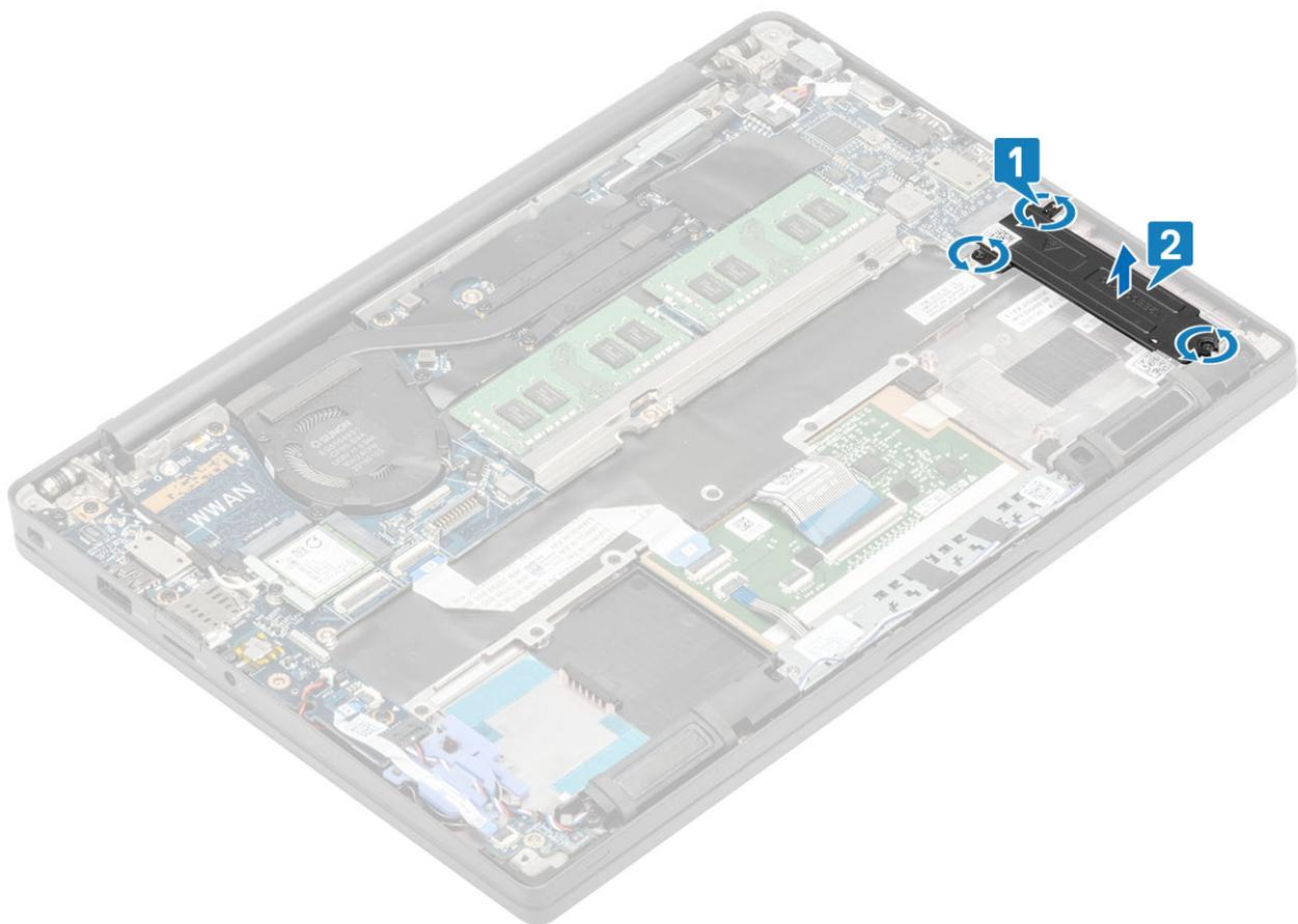
3. Levante um pouco e remova o módulo SSD do conector na placa de sistema.
