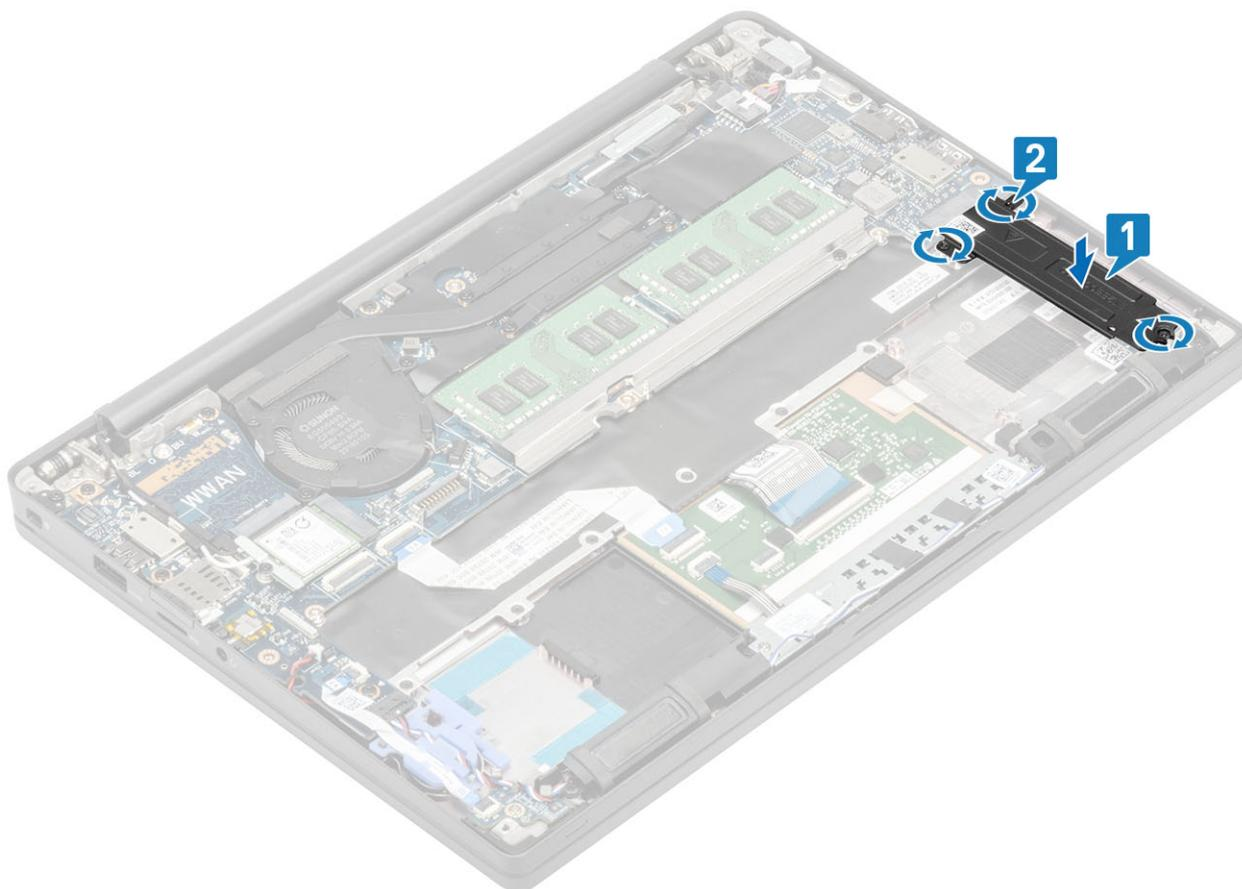
**NOTA:** Este procedimento ilustra um SSD M.2 2280. O M.2 2230 SSD requer um suporte especial e uma placa para prendê-lo ao conjunto do apoio para as mãos.
