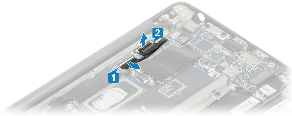
8. Desconecte o conector de cabo do touch pad da placa de sistema [1].
