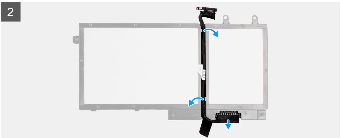
1. Retire a fita que fixa o cabo da bateria na bateria.
