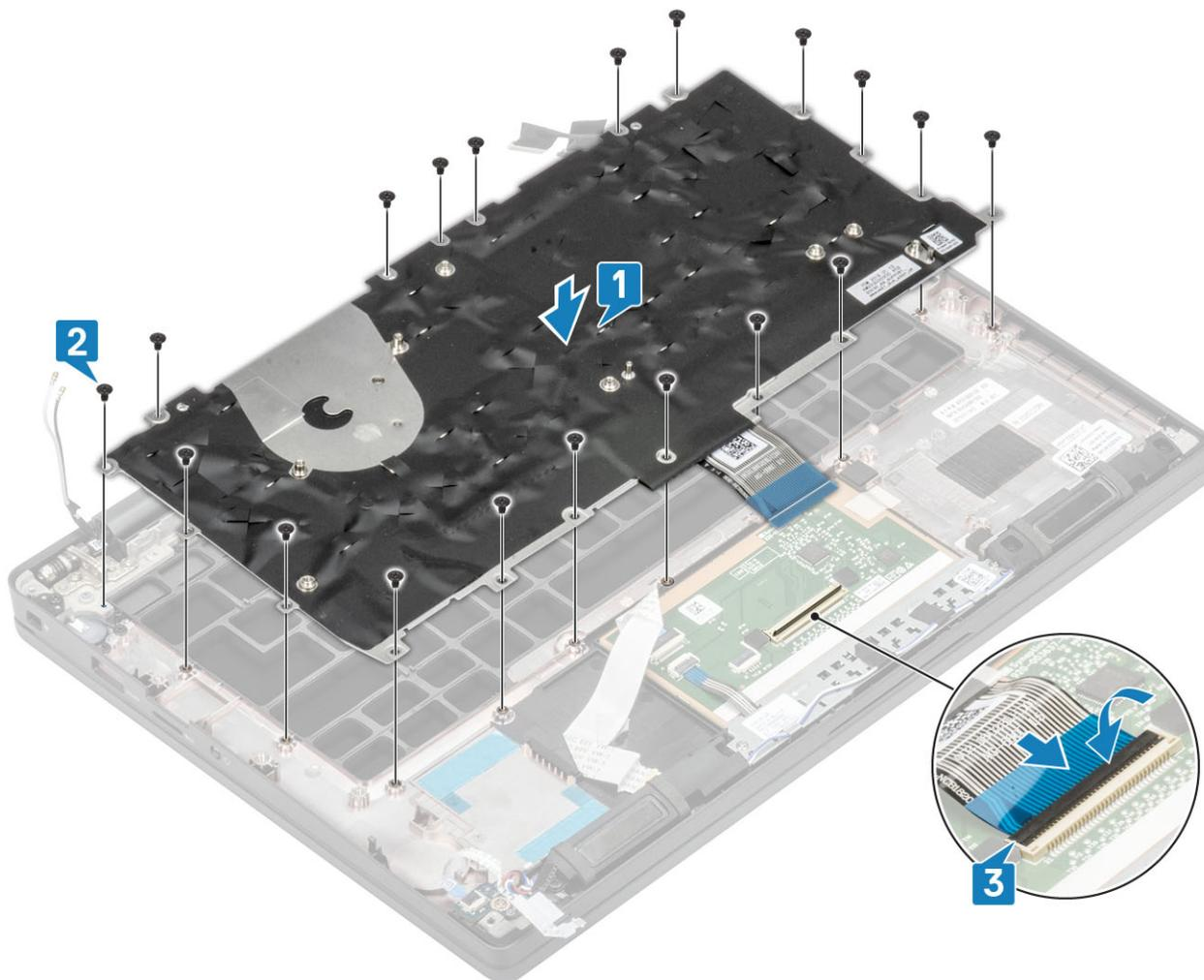
**NOTA:** Os teclados com iluminação traseira têm um cabo extra de luz de fundo para estar conectado ao módulo do touch pad.
