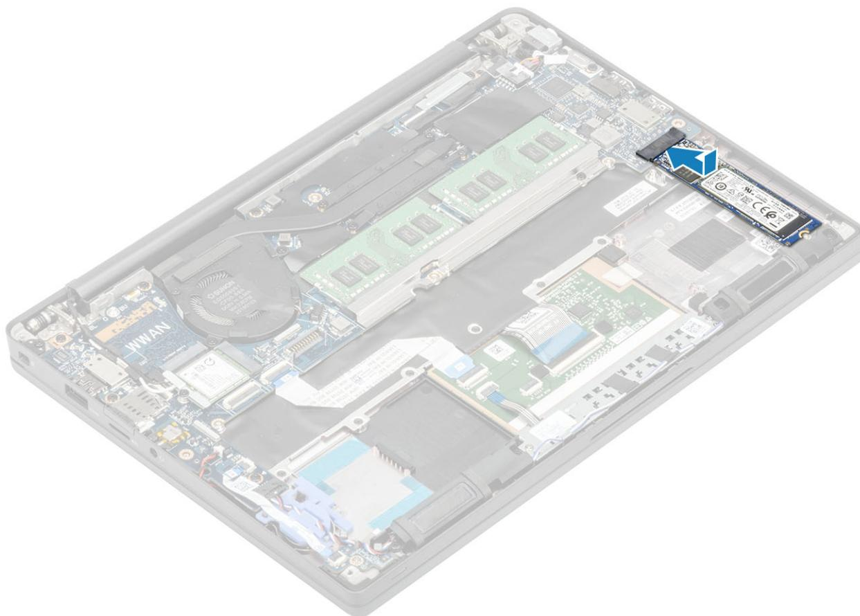
2. Coloque a placa SSD pré-instalada com adesivo térmico na parte inferior do SSD [1].
