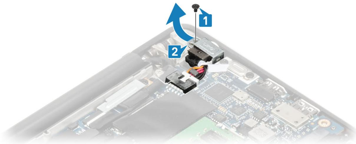
3. Desconecte o cabo da porta do adaptador de energia da placa de sistema [1].
