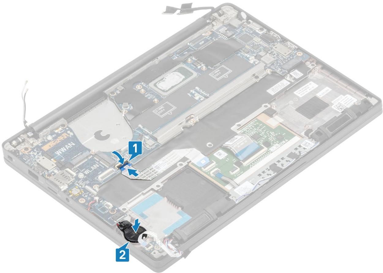
6. Conecte o cabo da tela à câmera de tela sensível ao toque [1] e os conectores do cabo EDP [2] à placa de sistema.
