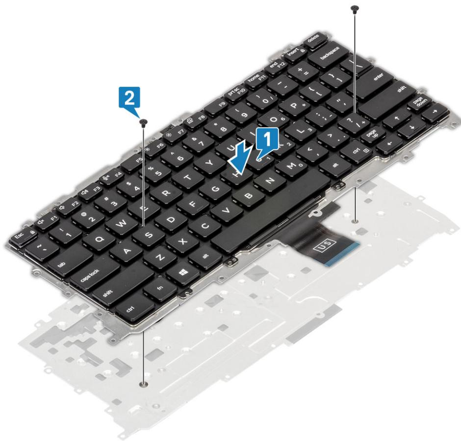
2. Coloque o conjunto do teclado no apoio para as mãos [1] e prenda-o com os 19 parafusos (M1,6x2) [2].
