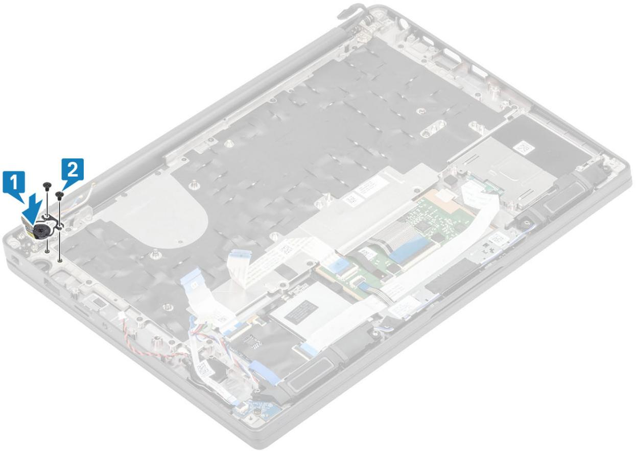
그림 6 . FPR이 포함된 전원 버튼 보드 설치
