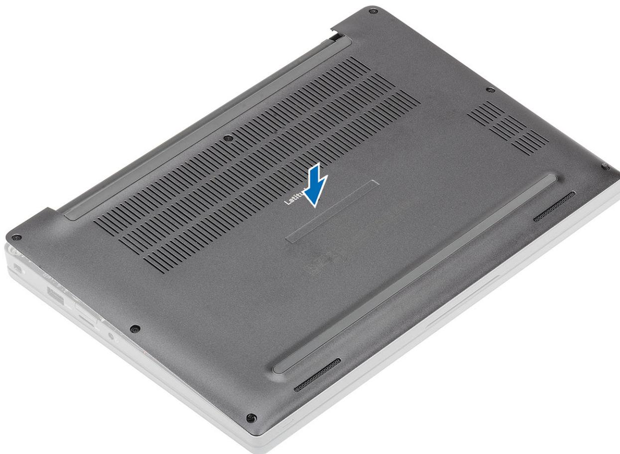
2. Appuyez sur les bords du cache de fond jusqu'à ce qu'il s'enclenche sur l'ensemble repose-mains.
