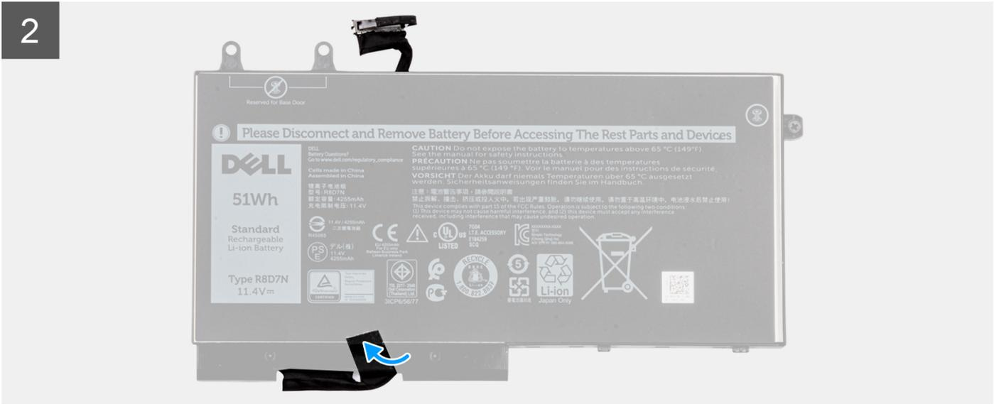
1. Placez le câble de la batterie en l'alignant sur la batterie.
