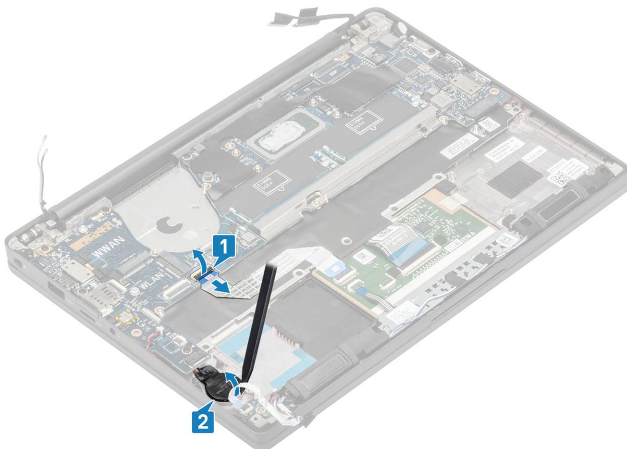
10. Retirez la vis (M2x4) [1], puis le support métallique sur les câbles d'antenne WWAN et Darwin [2].
