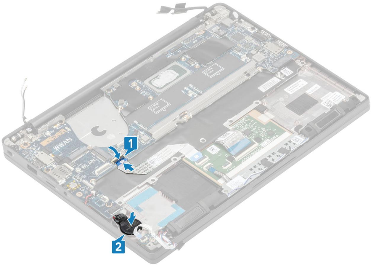
6. Branchez le câble de l'écran sur l'ensemble caméra-écran tactile [1] et les connecteurs du câble eDP [2] sur la carte système.
