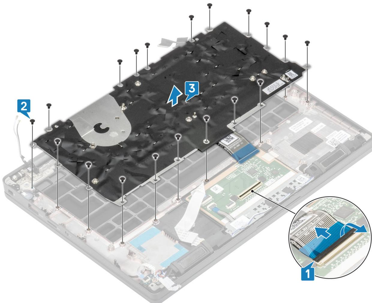
3. Retirez les deux vis (M2x2) [1] pour soulever le clavier de la plaque de support du clavier.
