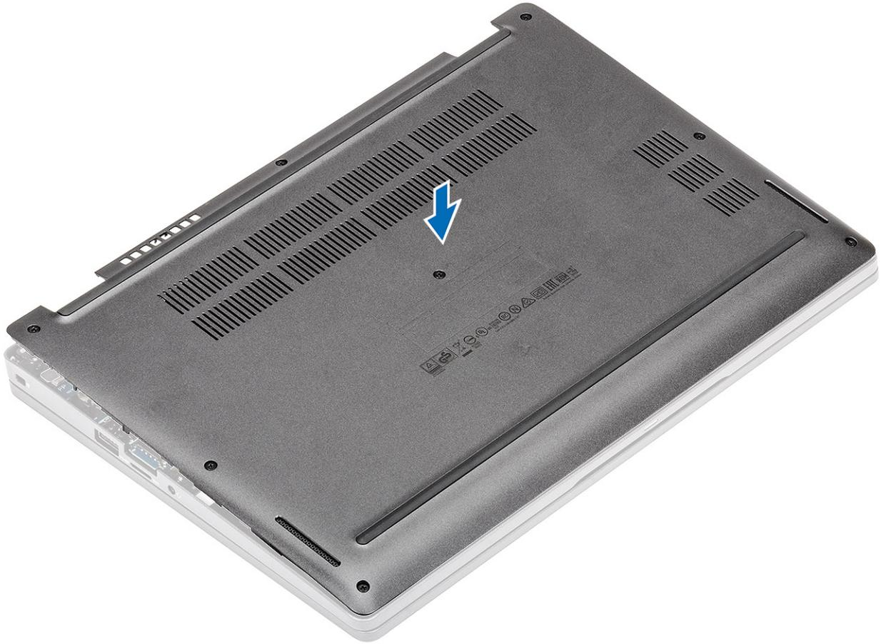
3. 按压基座护盖的边缘和侧面，直到卡入到位。
