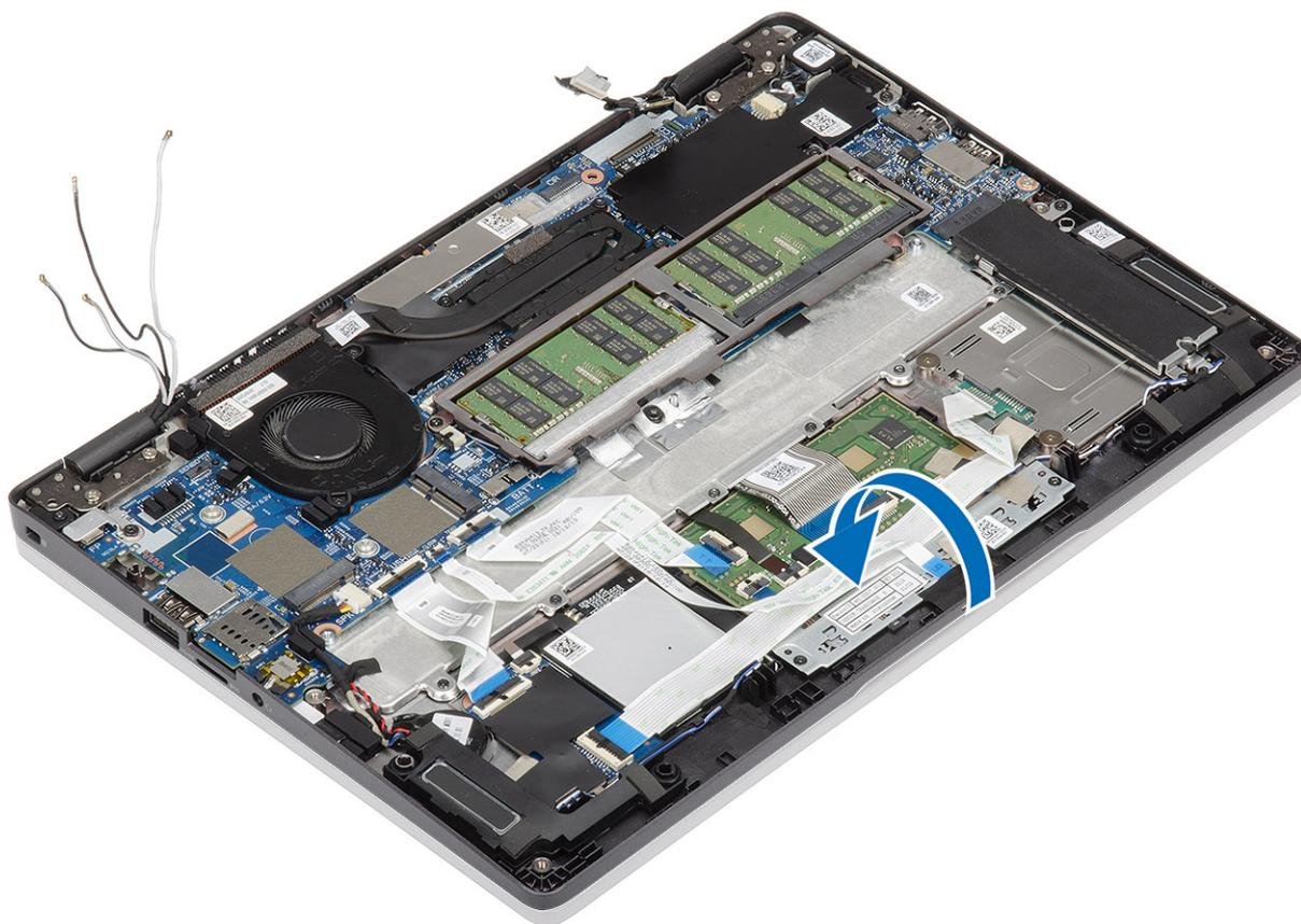
6. Retire os quatro parafusos (M2.5x4) que fixam o conjunto do ecrã ao chassis do sistema [1].
