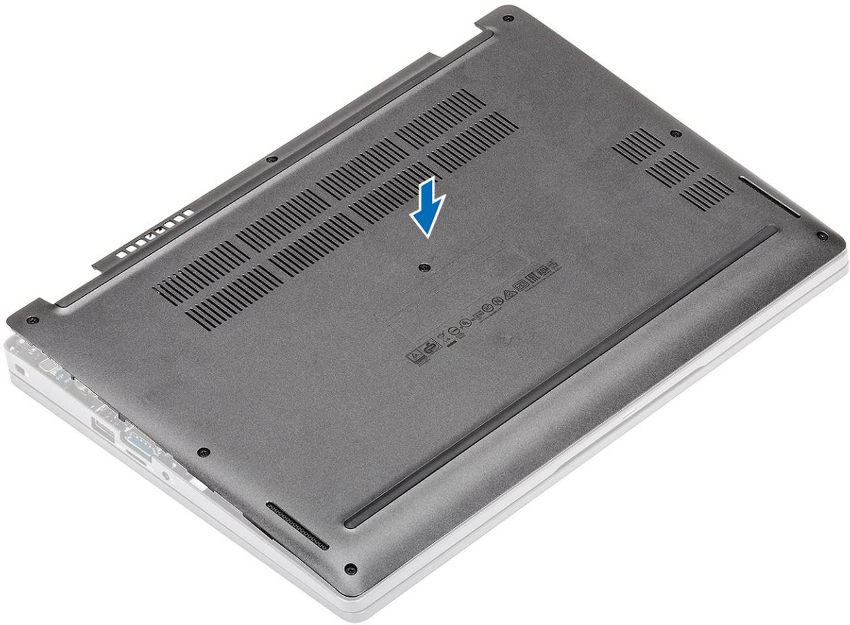
3. Drücken Sie auf die Kanten und die Seiten der Bodenabdeckung, bis die Abdeckung einrastet.
