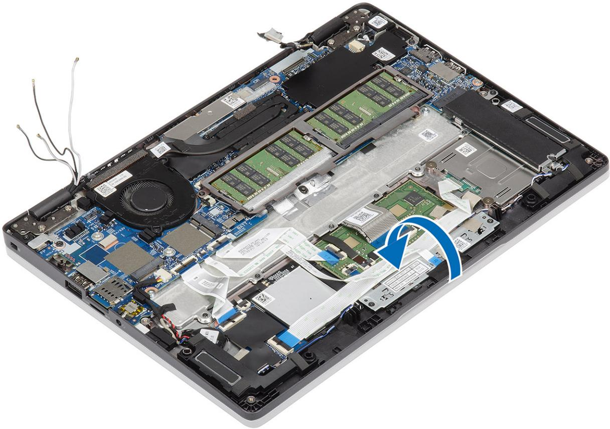
6. Entfernen Sie die vier Schrauben (M2,5x4), mit denen die Bildschirmbaugruppe am Systemgehäuse befestigt ist [1].
